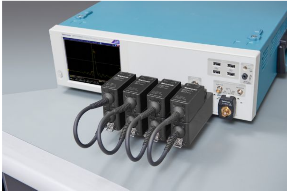
그림 3: DPO70E1 은 다중 광 입력 및 다중 캐리어 구성을 지원합니다.
