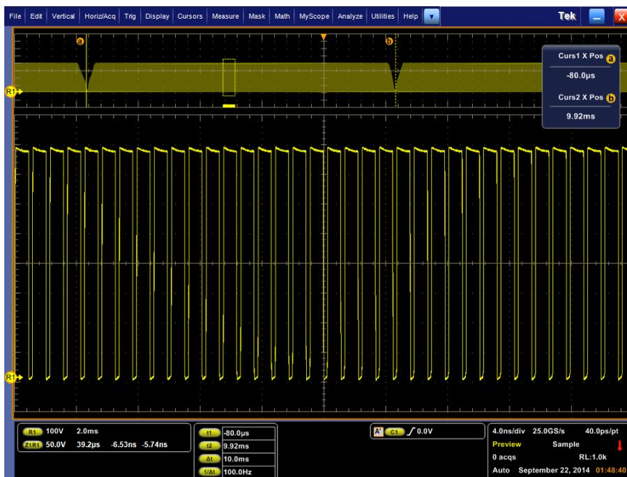
图 20: VDS 电压开关周期 (漏极-信号源) 放大图
