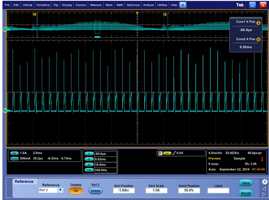
图 21: IDS 电流开关周期 (漏极-信号源) 放大图
