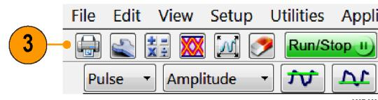
4. 要将屏幕图像复制到其他应用程序，请在打印对话框中选择 Print to file（打印到文件）。将屏幕图像保存为与应用程序兼容的格式，然后将屏幕图像插入文档即可。
