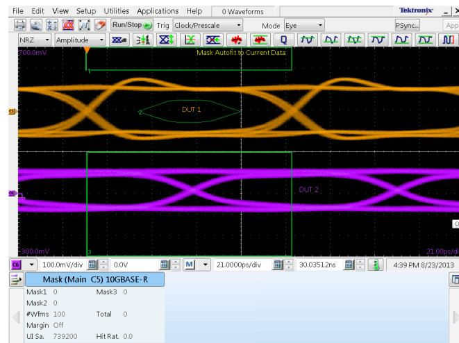
24. 重复步骤 22 和 23 按此模板测试每个已采集的通道。示例显示模板先自动适合到通道 1 波形，然后自动适合到通道 3 波形。
