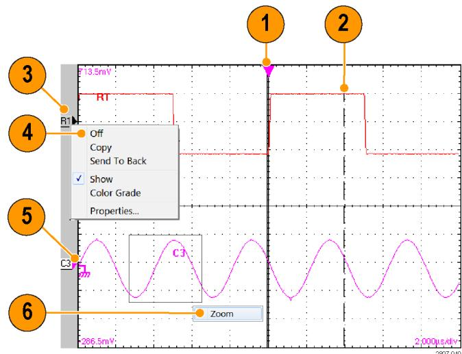
1. 拖动水平参考移动一个点，波形围绕此点进行水平扩展或收缩。
