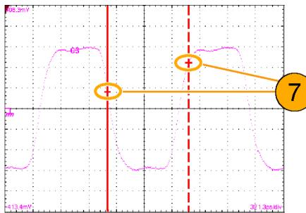
8. 读取显示器读数区域内的光标测量结果。
