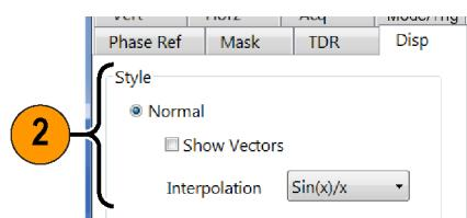
**Show Vectors** (显示矢量) 将打开波形点之间的连线，取消选择它将仅显示点。
