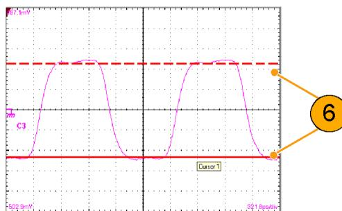
7. 波形光标同时测量垂直和水平参数。波形光标附在波形上，随着波形点移动。
