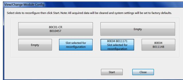
4. 仪器会通知何时可以拆卸或安装模块。仅从指示的插槽中删除或安装模块。在操作模块时要佩戴防静电腕带。
