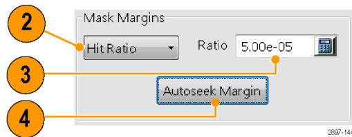
仪器将模板自动适配到累积的波形数据，然后对模板定标，直至达到最大大小，且产生的命中率小于或等于指定的命中率参数。
