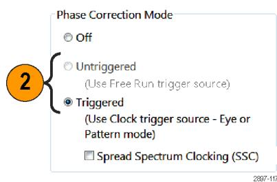
3. 如果所连接的相位参考时钟包含扩频时钟 (SSC) 调制, 请选择 **Spread Spectrum Clocking (SSC)** (扩频时钟 (SSC))。这可让仪器接受在相位参考输入时钟上施加最高 5000 ppm 的 SSC。
