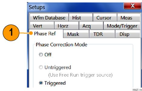
2. 通过选择 Untriggered (未触发) 或 Triggered (已触发) 将相位校正打开。
