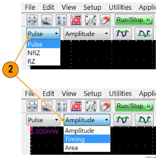
3. 单击 Measurement (测量) 工具栏上的测量按钮。仪器显示所选波形类型和类别的最常用测量。
