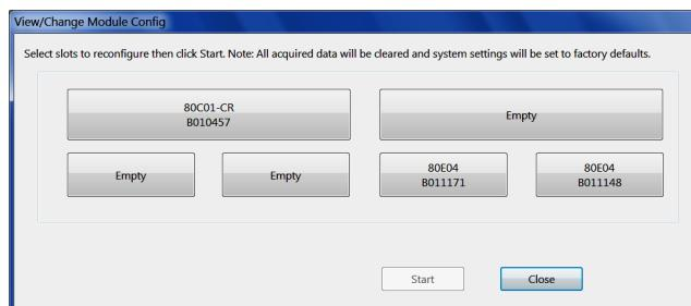
2. 单击需要更改的所有模块插槽，包括要拆卸模块以及要安装模块的插槽。
