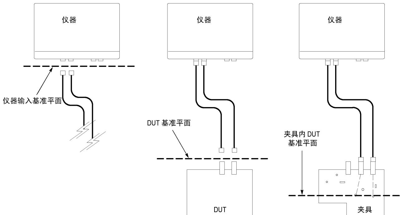
图 1：参考平面与信号相关的原理图
