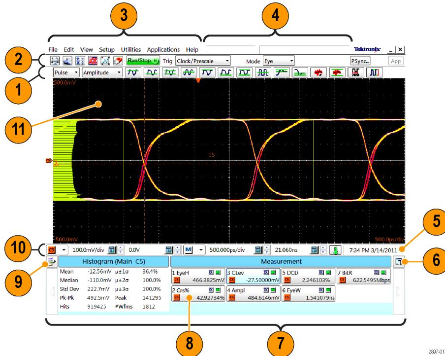
1. 测量栏。按信号类型访问自动化测量；单击测量按钮可测量选定的波形。
