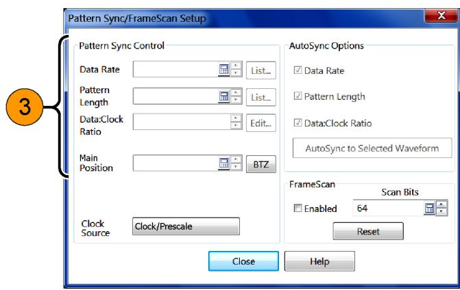
4. 使用 AutoSync 功能可自动检测所施加数据和时钟信号的数据速率、模式长度和/或数据时钟比（数据至取样模块通道，时钟至时钟/预定标触发输入，或者来自内部时钟恢复源）。
