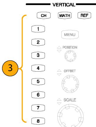
4. 使用垂直方向的 Position (位置)、Offset (偏置) 和 Scale (刻度) 旋钮来调整选定波形的垂直参数。
