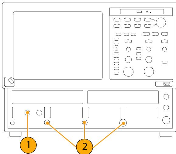
3. 按 **CH** 按钮（变成琥珀色）以指定波形按钮（1 - 8）来操作通道波形。然后选择正确的波形按钮。
