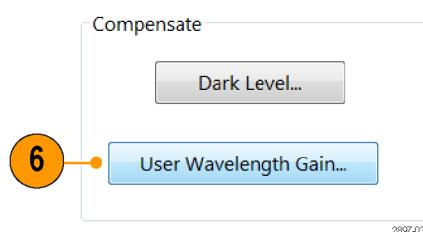
7. В диалоговом окне User Wavelength Gain Compensation (Компенсация коэффициента усиления пользовательской длины волны) задайте длину волны и мощность сигнала, подаваемого в канал.
