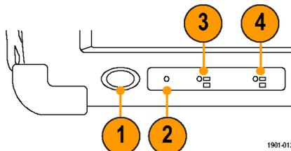
2. Кнопка Reset (Сброс). Применяется для аппаратной перезагрузки. Все программы и данные, находящиеся в энергозависимой памяти, стираются. Обычно используется только для восстановления после «зависания» системы. Для нажатия на кнопку сброса воспользуйтесь тонким щупом.
