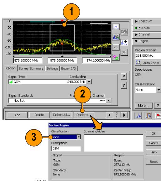
4. Коснитесь поля **Description** (Описание), чтобы ввести краткое описание длиной не более 14 символов. По умолчанию значению этого поля присвоен тип сигнала, установленный на вкладке Region (Зона), но при желании его можно изменить. Для ввода символов используйте экранную клавиатуру панели ввода WindowsCE или клавиатуру, подключенную через порт PS/2 прибора. (См. стр. 15, *Элементы управления вводом параметров.*)
