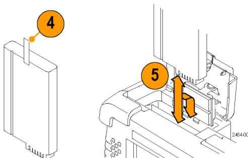
Чтобы увеличить время эксплуатации, во второе гнездо можно установить еще одну батарею. Используйте только батареи указанного типа. При покупке аккумуляторной батареи обратитесь в Центр обслуживания Tektronix, чтобы уточнить ее правильный номер по каталогу.
