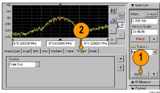
3. Коснитесь поля **Source** (Источник) и выберите тип синхронизации. Настройка **External** (Внешний) требует наличия сигнала запуска ТТЛ-уровня на разъеме **Trigger/Timing** (Запуск/синхронизация). Чтобы выключить синхронизацию, выберите пункт **Free Run** (Без синхронизации) из списка **Source** (Источник).
