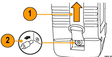
3. Подключите адаптер переменного тока к правильно заземленному источнику переменного тока при помощи прилагаемого шнура питания.
