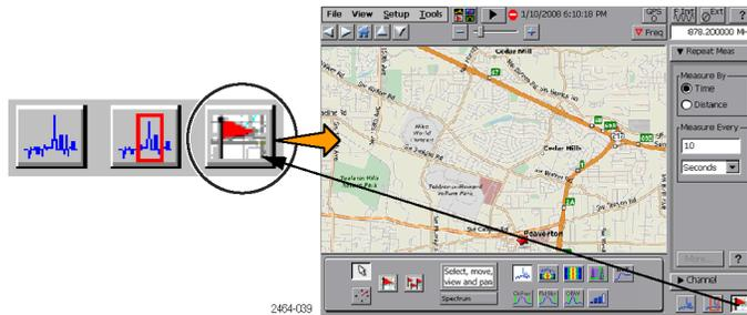
Имеется возможность загружать отсканированные файлы точечной графики для использования в качестве карт внутри помещений, или файлы форматов GSF и MIF для использования вне помещений. Наличие файлов формата GSF или MIF позволяет использовать встроенный приемник GPS для автоматической привязки измерений к текущим координатам.
