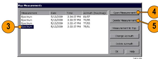
6. Чтобы переместить выбранное измерение в начало списка, коснитесь кнопки **Measurement to Top** (Переместить измерение наверх).
