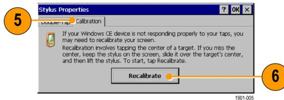
7. Следуйте инструкциям на экране с указателем. Когда указатель положения исчезнет, коснитесь экрана в любом месте, чтобы вернуться на вкладку Calibration (Калибровка).
