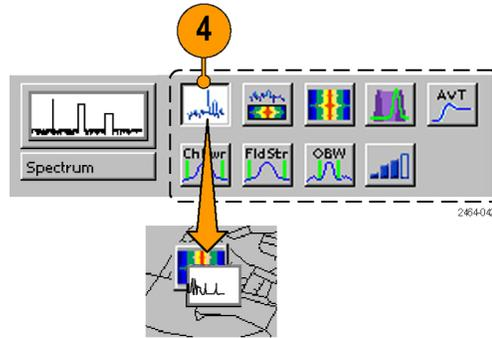
5. Для перемещения значка коснитесь кнопки **Select** (Выбрать), затем коснитесь значка и перетащите его в новое место. Если измерение находится в стопке, состоящей из нескольких измерений (например, созданных в результате регистрации большого количества данных), iMap перемещает значок, находящийся на самом верху стопки. Если значок перемещается в новую стопку значков измерений, порядок его размещения определяется временем проведения измерения.
