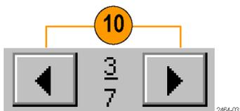
Верхнее число соответствует номеру текущей зоны, нижнее — общему числу зон. Перечисление зон идет от зон с меньшей частотой (левый край сигнала) к зонам с большей частотой. По мере добавления или удаления зон, присвоенный конкретной зоне номер может изменяться.
