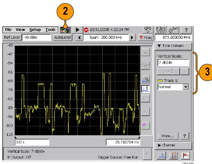
4. Коснитесь на панели Time Domain (Временной интервал) кнопки **More** (Дополнительно), чтобы отобразить вкладки параметров спектра.
