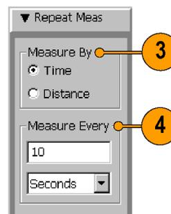
4. Коснитесь поля в области **Measure Every** (Интервал измерения), чтобы установить интервал измерений.
