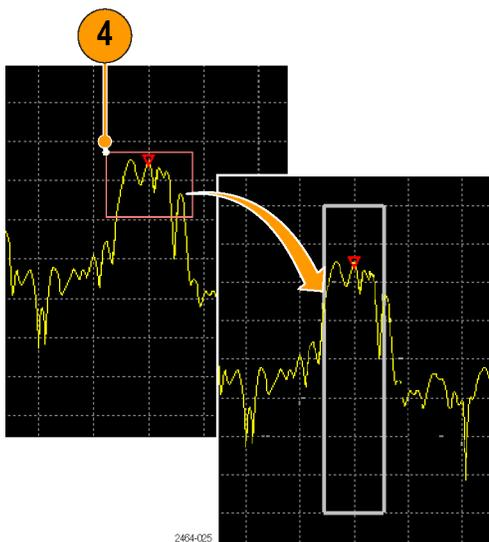
5. Коснитесь поля **Region Span** (Диапазон зоны), чтобы ввести точное значение частотного диапазона зоны.
