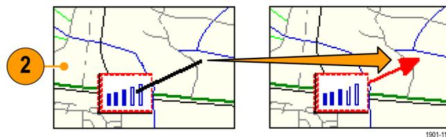
В области миниатюр измерений iMap отображается направление стрелки. Отображаемая информация зависит от типа карты (с координатной сеткой или графическая). В примере представлена карта с координатной сеткой. Показания на миниатюре помогут установить направление стрелки измерения.
