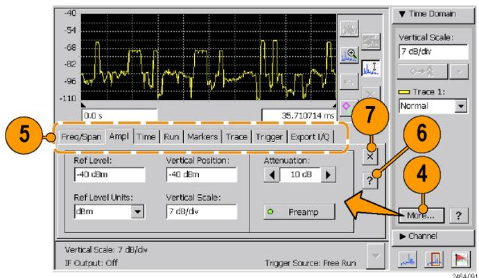
8. Для отображения представляющего интерес участка осциллограммы используйте кнопки **Zoom** (Масштабирование) и **Pan Display** (Панорамирование отображения).
