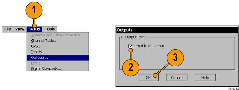
**ПРИМЕЧАНИЕ.** Включение выходного ПЧ-сигнала приводит к тому, что измерения, производимые прибором, получаются некалиброванными. Пока включен выходной ПЧ-сигнал, на приборе отображается соответствующее предупреждение и кнопка **UNCAL** (НЕКАЛИБРОВАН). Чтобы вернуть прибор в состояние, когда производимые измерения получаются калиброванными, снимите флажок **Enable IF Output** (Включить выходной ПЧ-сигнал) в диалоговом окне **Outputs** (Выходные сигналы).
