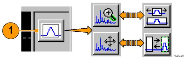
2. Чтобы изменить ширину (диапазон частот) зоны, коснитесь кнопки **Change Span** (Изменить диапазон).
