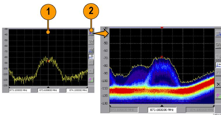
3. Коснитесь на панели спектра DPX кнопки **More** (Дополнительно), чтобы отобразить вкладки с параметрами спектра DPX.
