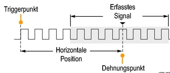
1. Passen Sie durch Drehen des Drehknopfs **Horizontal Position** die horizontale Position (Verzögerungszeit) an.
