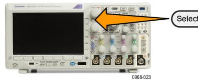
Zum Ändern der Bezeichnung können Sie bei Bedarf die Tasten auf dem unteren Rahmen verwenden.
