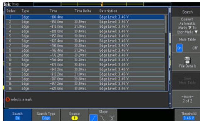
4. Auf dem Bildschirm werden durch leere Dreiecke die Positionen automatischer Markierungen und durch gefüllte Dreiecke benutzerdefinierte Positionen angegeben. Diese werden sowohl in normalen als auch in zoomten Signalansichten angezeigt.
