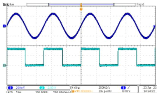
Das Sinussignal von Kanal 1 zeigt den Ausgang des AFG. Das Rechtecksignal von Kanal 2 zeigt den Ausgang des AFG Sync-Impulses, der aus dem AUX OUT-Anschluss stammt.
