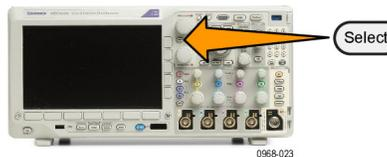
Zum Ändern des Namens können Sie bei Bedarf die Tasten auf dem unteren Rahmen verwenden.
