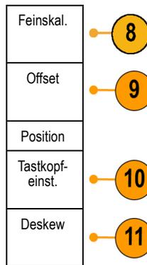
9. Wählen Sie **Offset**, um mithilfe von **Mehrzweck a** die Abstimmung des vertikalen Offsets vornehmen zu können.
