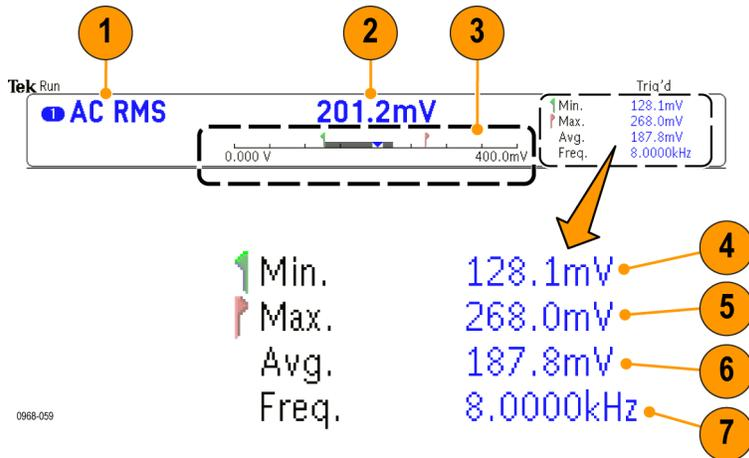
1. Messungsart (AC+DC Eff, DC, AC Eff oder Frequenz)
