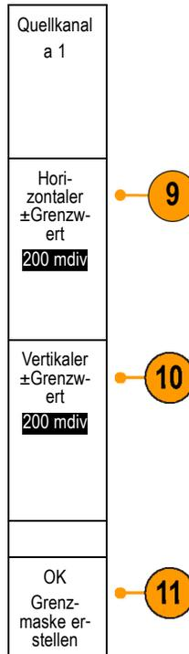
**Eine benutzerdefinierte Maske erstellen.** Es gibt zwei Möglichkeiten, eine benutzerdefinierte Maske zu erstellen. Sie können eine Maske aus einer Textdatei laden oder eine Maske über eine Remote-Schnittstelle erstellen.
