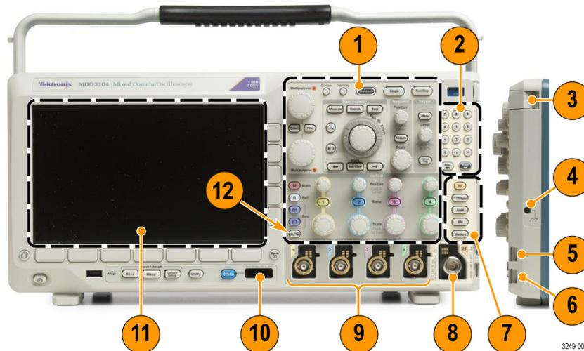
1. Herkömmliche Bedienelemente auf dem Frontpaneel des Oszilloskops
