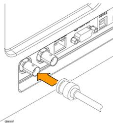
Um den Ausgang des AFG anzuzeigen, schließen Sie das andere Ende des Kabels an einen der Eingangskanäle auf der Vorderseite des Oszilloskops an.
