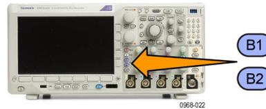
2. Drücken Sie eine Taste auf dem unteren Rahmen, um eine Bezeichnung zu erstellen, z. B. für Kanal 1 oder B1.
