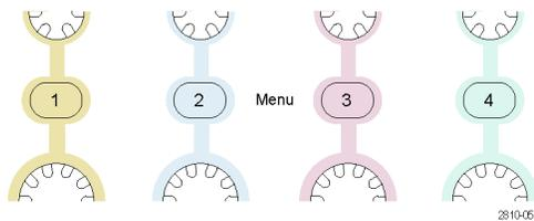
Durch Drücken einer Kanaltaste wird auch ein Signal ausgewählt oder diese Auswahl aufgehoben.
