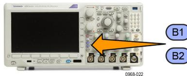
2. Drehen Sie den Drehknopf **Mehrzweck a**, um die vertikale Position des gewählten Busses einzustellen.
