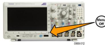
3. Lassen Sie die Taste **Menu Off** los, und lassen Sie anschließend die Taste **Auto-Setup** los.
