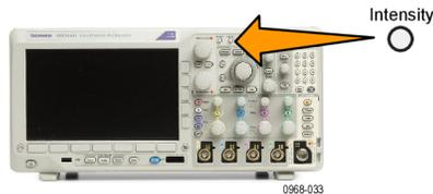
Dadurch wird die Anzeige für die Intensität auf dem Bildschirm angezeigt.
