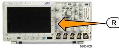
2. Drücken Sie auf dem unteren Rahmen die Taste **R1**, **R2**, **R3** oder **R4**, um das Referenzsignal oder den Referenzstrahl aus der Anzeige zu entfernen.
