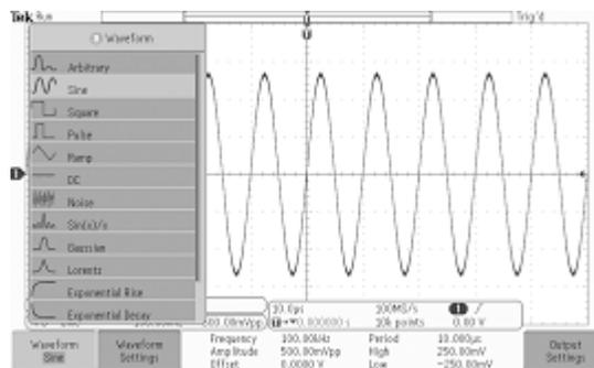
3. Drücken Sie im unteren Menü „AFG“ die Taste **Signaleinstellung.**, um Frequenz, Periode, Amplitude, Offset sowie den hohen und niedrigen Pegel des gewünschten Signals einzustellen.
