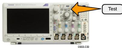
5. Drücken Sie im unteren Menü die Option **Anwendung**. Drehen Sie **Mehrzweck a**, um in dem Menü die Option **Grenzwert-/Maskentest** auszuwählen.
