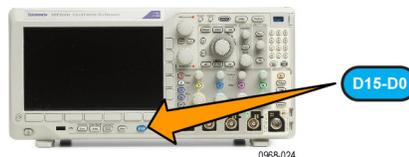
6. Drücken Sie die untere Rahmentaste **D15 - D0**, um auf das Menü „Ein“ oder „Aus“ für D15 - D0 zuzugreifen.
