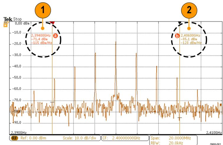
3. Die Delta-Anzeigen für Frequenz und Amplitude werden oben in der Anzeige dargestellt.
