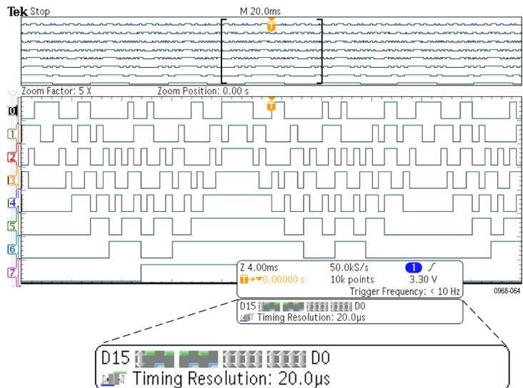
11. Drücken Sie die untere Rahmentaste **MagniVu**, um die Timingauflösung zu erhöhen. (Siehe Seite 87, *Gründe für die Verwendung von MagiVu.*)
