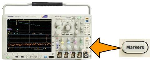
2. **Peak Markers** (ピーク・マーカ) を押し、**汎用 a** を回して、画面でラベルを付けるピークの数を選択します。
