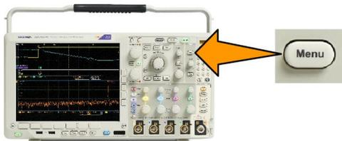
2. Type(トリガ種類)を押して、Trigger Type(トリガ種類)サイド・メニューを表示します。
