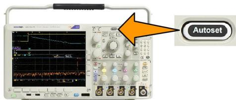
3. 必要に応じて、**Undo Autoset** (オートセット実行前の設定) を押して、直前のオートセットを取り消します。
