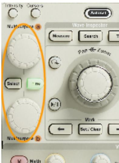
6. **Fine** (微調整) を押すと、より微細な調整機能のオン／オフを切り替えることができます。
