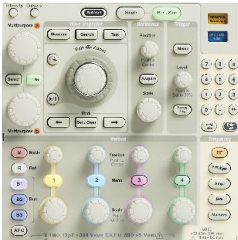
2. 下位メニュー・ボタンを押します。ポップアウト・メニューが表示された場合は、汎用ノブ a を回して目的の項目を選択します。ポップアップ・メニューが表示された場合は、ボタンを再度押して、目的の項目を選択します。
