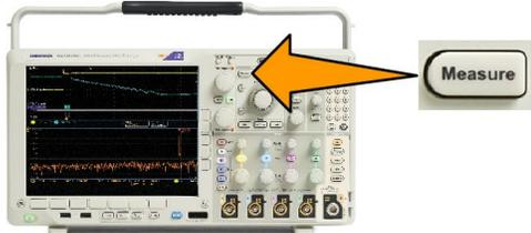
2. **More** を必要な回数だけ押して、表示されたポップアップ・メニューから **Reference Levels** (基準レベル) を選択します。
