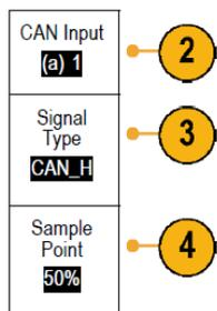
3. 旋转“通用 a”选择 CAN 信号类型：CAN\_H、CAN\_L、Rx、Tx 或差分。
