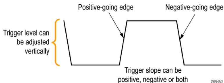
1. 旋转前面板“触发”部分的“电平”旋钮，无需进入菜单即可调整触发电平。
