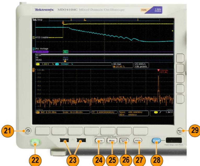
21. **Print（打印）。** 按此按钮即可打印到所选的打印机。
