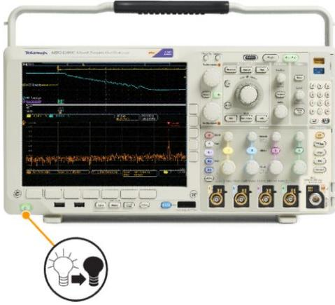
要将仪器断电，将示波器前面板上的电源按钮切换到关闭，然后取下电源线。
