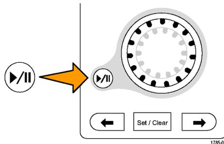
3. 反向旋转平移旋钮改变播放方向。
