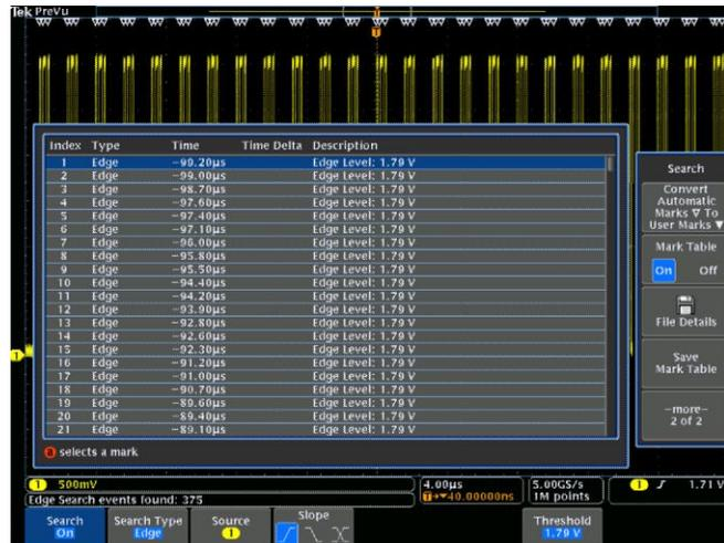
4. 在屏幕上，空心三角显示自动标记的位置，而实心三角显示自定义（用户定义）的位置。它们会出现在正常波形视图和缩放波形视图上。
