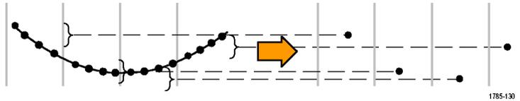
“**包络**”模式在所有采集中查找最高和最低记录点。“包络”模式对每个单独的采集使用“峰值检测”。
