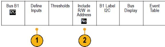
可将预定义的 SCLK 输入或 SDA 输入分配到信号所连的通道。
