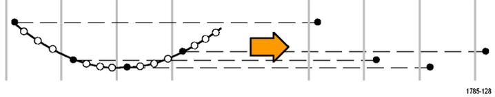
“**峰值检测**”模式使用了两个连续捕获间隔中包含的所有取样的最高和最低点。该模式仅可用于实时、非内插的取样，在捕获高频率的毛刺方面非常有用。
