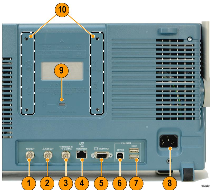
1. **AFG OUT (任意波形发生器输出)**。使用 AFG OUT (任意波形发生器输出) 端口传输来自任意函数发生器的信号。
