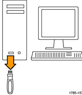
解压文件并将 firmware.img 文件复制到 USB 闪存驱动器或 USB 硬盘驱动器的根文件夹内。
