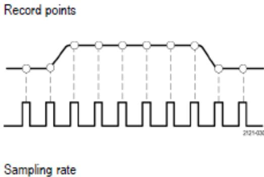
MDO4000C 系列示波器使用实时取样。在实时取样中，仪器对通过单触发事件采集的所有点都进行数字化。
