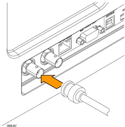
若要查看 AFG 输出, 请将电缆的另一端连接至示波器正面的输入通道之一。
