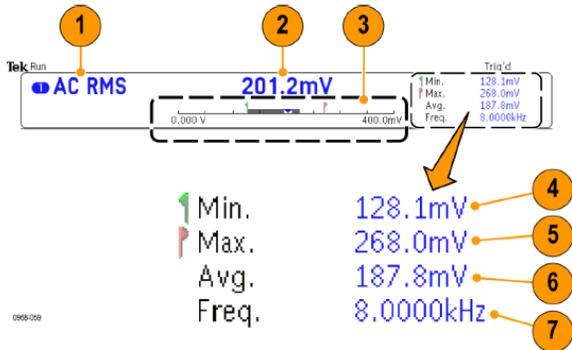
1. 测量类型 (AC+DC RMS、直流、AC RMS 或频率)
