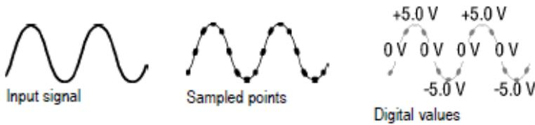
采集过程如下：对模拟信号进行取样，再将取样转换为数字数据，然后将数字数据集合为波形记录，最后将波形记录存储在采集存储器中。
