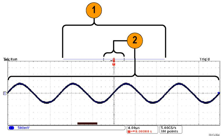
2. 在用方括号定义的部分上方显示屏内显示时域方格图中显示的部分采集。
