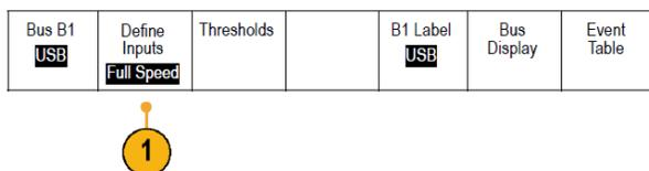
1. 如果选择 **USB**，请按“定义输入”设置 USB 总线速率和探头类型。
