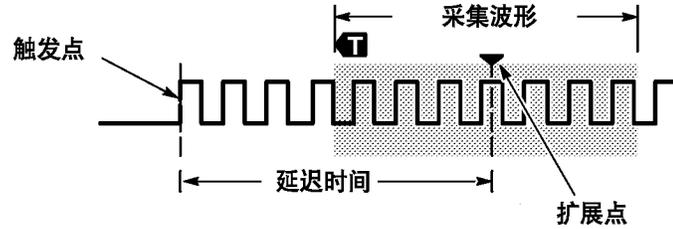
当“延迟”设为“开启”时，顺时针旋转“水平位置”旋钮增加延迟。触发点将向左边移动，最终达到采集的波形之外。然后，可调整“水平标度”旋钮来采集屏幕中央兴趣区周围的更多细节。
