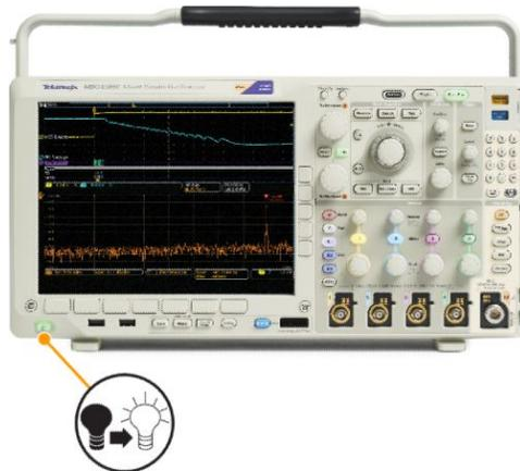
**注意：**在示波器完成固件安装之前，请勿关闭示波器电源或移除 USB 驱动器。
