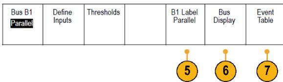
6. 按“总线显示”并使用侧面菜单定义如何显示并行或串行总线。
