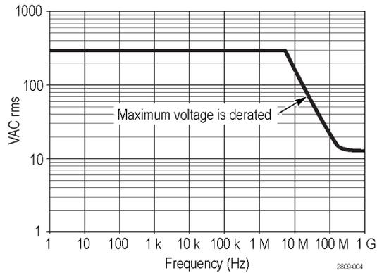
在进行浮动测量时，请参考上面的基准引线降额曲线。
