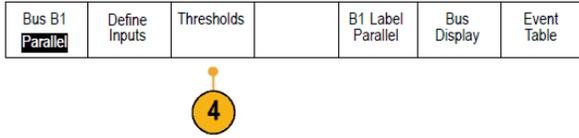
可通过预置值列表设置并行或串行总线中所有通道的阈值。根据总线类型的不同，预置值也有所不同。或者，可对于构成并行或串行总线的信号将阈值设为特定值。设置方法为按“**选择**”侧面菜单按钮，旋转“**通用 a**”选择一个位或通道编号（信号名称）。
