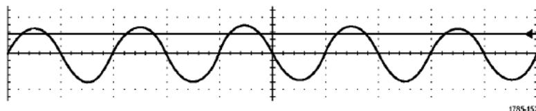
2. 按下前面板“触发”部分的“电平”旋钮可将触发电平快速设为波形的中点。
