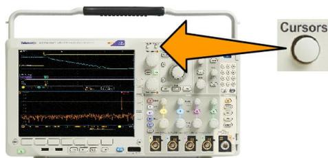
在本例中，选定的波形上将出现两个垂直光标。旋转通用旋钮 a 时，可以将一个光标向左或右移动。旋转旋钮 b 时，可以移动另一个光标。
