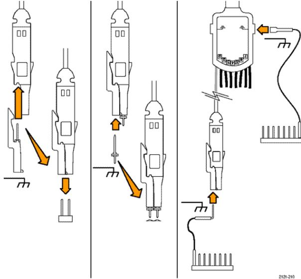
2. 将一根或多根接地导线连接到电路接地点。
