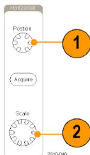
触发前的记录部分为预触发部分。触发后的记录部分为触发后部分。预触发数据可以帮助排除故障。例如，要找到测试电路中出现多余毛刺的原因，可以触发毛刺并使预触发周期足够长，以便捕获到毛刺出现之前的数据。通过分析毛刺产生之前所发生的数据，可以找出有助于发现毛刺来源的信息。另外，如果要查看系统中触发事件的结果，请将后触发周期增加到足够长以捕获触发之后的数据
