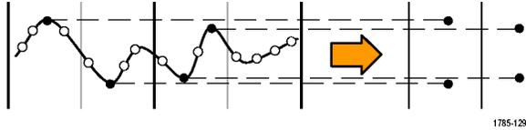
“**高分辨率**”模式为每个捕获间隔计算所有取样的平均值。该模式也只能用于实时、非内插取样。“高分辨率”模式提供较高分辨率、较低带宽的波形。
