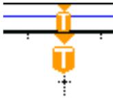
4. 波形记录视图显示相对于波形记录的触发位置。线的颜色与选定波形颜色相对应。括号显示屏幕上当前显示的记录部分。
