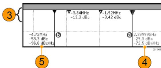
4. 手动标记 a 的第三条线始终显示噪声密度 (dBm/Hz)。
