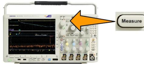
4. Wählen Sie im seitlichen Menü eine Frequenzbereichsmessung aus.
