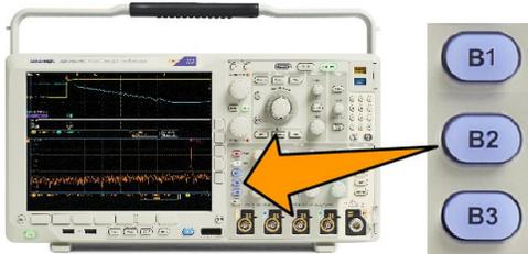
2. Drehen Sie den Drehknopf **Mehrzweck a**, um die vertikale Position des gewählten Busses einzustellen.
