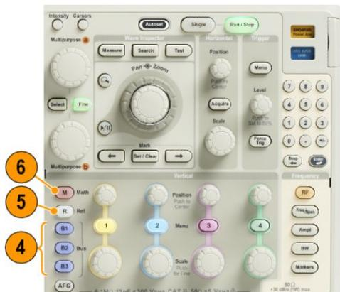
5. **R**. Drücken Sie diese Taste, um Referenzsignale und -strahlen zu verwalten, einschließlich Ein- oder Ausblenden einzelner Referenzsignale oder -strahlen auf der Anzeige.
