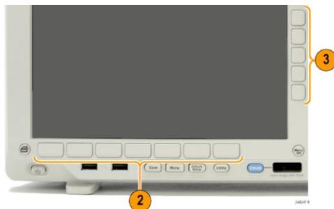
4. Um ein seitliches Menü zu entfernen, drücken Sie erneut die Taste des unteren Menüs oder die Taste **Menu Off** (Menü aus).
