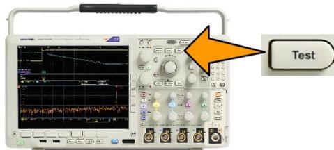
5. Drücken Sie im unteren Menü die Option **Anwendung**. Drehen Sie **Mehrweck a**, um in dem Menü die Option **Grenzwert-/Maskentest** auszuwählen.
