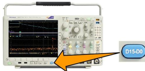
6. Drücken Sie im unteren Menü auf **D15-D0**, um auf das Menü „D15-D0 Ein/ Aus“ zuzugreifen.
