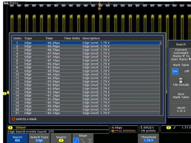
4. Auf dem Bildschirm werden durch leere Dreiecke die Positionen automatischer Markierungen und durch gefüllte Dreiecke benutzerdefinierte Positionen angegeben. Diese werden sowohl in normalen als auch in gezoomten Signalansichten angezeigt.
