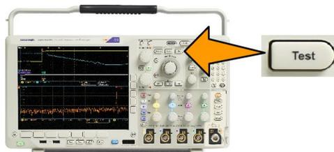
5. 按下方功能表上的應用。旋轉**多功能旋鈕 a**，從功能表中選擇**極限/遮罩測試**。
