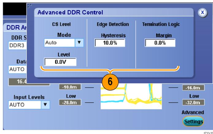
7. При выборе источника сигнала CS выбора отображаются значения Min CAS и Max CAS. Введите минимальное и максимальное значения диапазона для сигнала CS выбора
