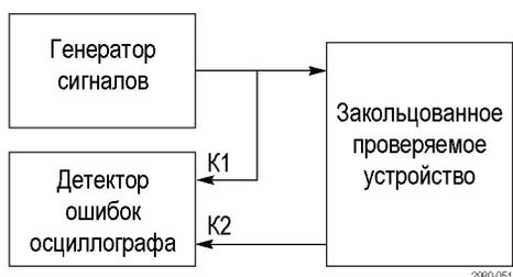
21. Если детектор ошибок запускается через интерфейс пользователя, везде, где возможно, используется синхронизация по шине, чтобы декодирование шины активировалось автоматически. Decoding (Декодирование) указывает место ошибки в сигнале, выделяя декодированное значение красным цветом, как показано на снимке экрана снизу. Можно использовать дополнительные каналы осциллографа для одновременной апробации других сигналов и устранения причины ошибки.
