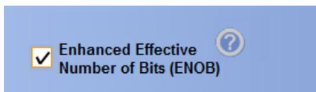
1. Установите или снимите флажок **Enhanced Effective Number of Bits** (расширенное эффективное число битов) для включения или выключения ENOB. Этот элемент управления находится во вкладке Acquisition (регистрация) в окне управления Horizontal/Acquisition (по горизонтали/регистрация).
