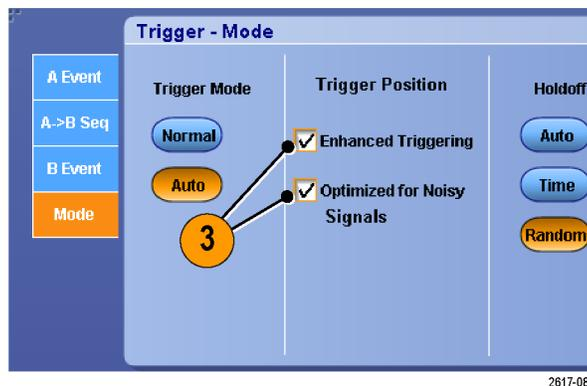
4. Выберите запуск по n-ному событию и сканирование события B на вкладке A>B Seq (последовательность A>B).
