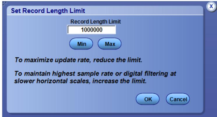
В режиме Constant Sample Rate можно настроить параметры Sample Rate и Scale. Частота выборки по умолчанию обеспечивает работу фильтра полосы пропускания. Длина записи является независимой переменной. Максимальная длина записи зависит от модели прибора и параметра длины записи.
