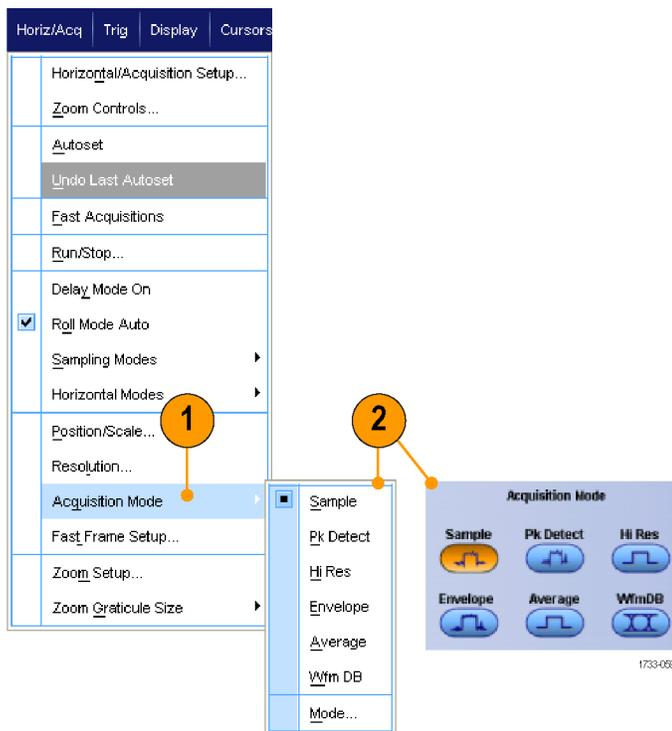
3. Для режимов регистрации Average или Envelope щелкните **# of Wfms**, а затем установите количество сигналов с помощью многофункционального регулятора. Для режима WfmDB щелкните **Samples**, а затем установите количество выборок с помощью многофункционального регулятора.
