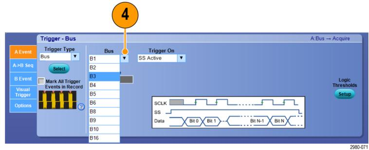
5. Выберите сигнал шины, по которому должна производиться синхронизация.
