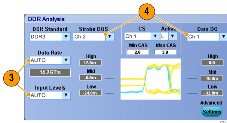
5. Выберите дополнительно: сигнал CS выбора и активный уровень сигнала CS выбора. Сигнал CS выбора определяет измерения DDR.
