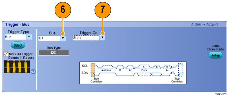
8. В зависимости от выбора **Trigger On** (синхронизация по), возможно, потребуется осуществить дополнительный выбор.
