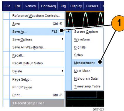
2. Чтобы определить Displayed Measurements (отображенные измерения), Measurement Snapshot (снимок измерения) или Measurement Format (формат измерения), нажмите кнопку **Options...** (параметры...). В противном случае перейдите к шагу 3.
