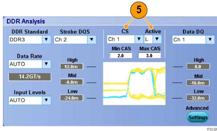
6. Дополнительно установите «mode» и «level» для сигнала CS выбора, «edge detection hysteresis» и «termination logic margin» путем нажатия **Advanced Settings**:
