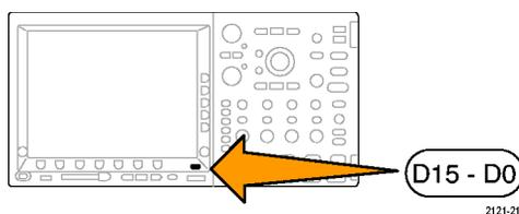
2. Выберите **Digital > MagniVu** (цифровой сигнал > MagniVu) и установите для режима MagniVu значение **On** (включить).
