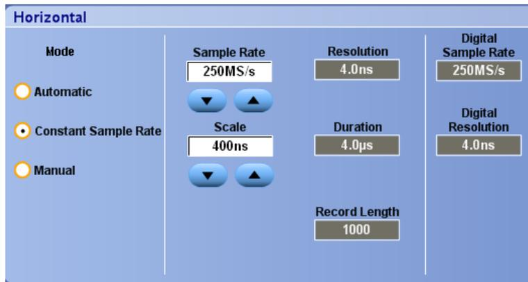
В ручном режиме можно настроить параметры Sample Rate и Record Length. Horizontal Scale является независимой переменной, которая вычисляется в зависимости от частоты выборки и длины записи.
