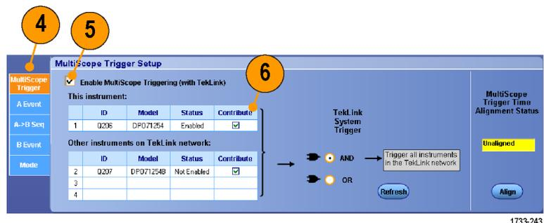
6. Выберите **Contribute**, чтобы настроить отправку сигнала синхронизации с данного прибора на другие приборы, для которых установлено соединение с помощью средств TekLink. Другие инструменты автоматически настраиваются на прием сигнала синхронизации.
