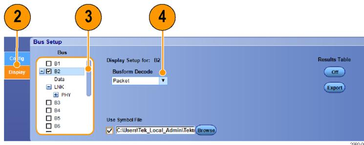
5. Щелкните «+» чтобы развернуть (отобразить дополнительные пункты) или «-», чтобы свернуть список.
