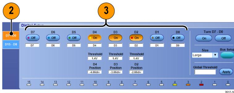
4. Щелкните **Threshold** (порог) или **Position** (положение) и установите их соответствующие значения при помощи клавиатуры или многофункциональных регуляторов. Или установите порог для всех 16 каналов, введя значение **Global Threshold** (общий порог) и нажав кнопку **Apply** (применить).
