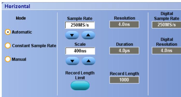
Чтобы задать значение ограничения длины записи, нажмите кнопку **Record Length Limit** и установите ограничение с помощью кнопок или клавиатуры. Максимальное ограничение по умолчанию зависит от модели прибора и параметра длины записи.
