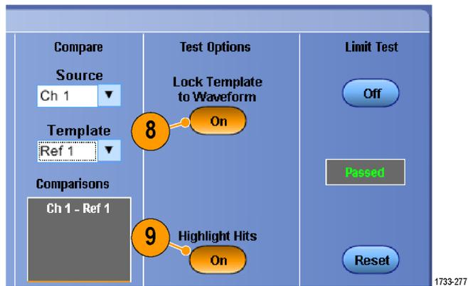
10. Включите Limit Test, чтобы начать тестирование.
