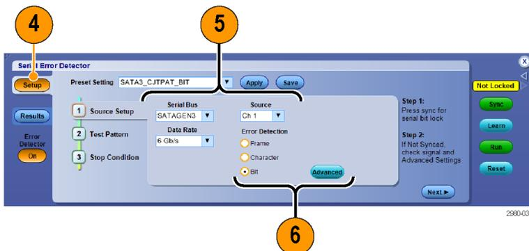
При нажатии кнопки **Advanced** (Дополнительные настройки) откроется окно дополнительных настроек. Окно дополнительных настроек содержит элементы управления параметрами, которые требуют изменения для проведения особого вида тестирования. Установленные для этих параметров значения по умолчанию верны для большинства устройств.
