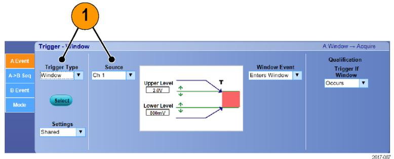
2. Задайте тип и источник синхронизации В на вкладке события В Event.
