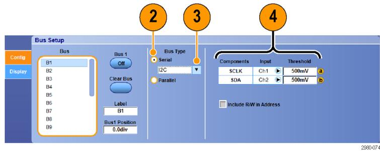
5. Выберите Trig > Bus Setup (синхронизация > настройка шины).
