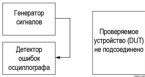
19. Выполнив необходимые соединения для операции сохранения шаблона сигнала, вставьте проверяемое устройство (DUT) между генератором сигналов и детектором ошибок, как показано на рисунке.
