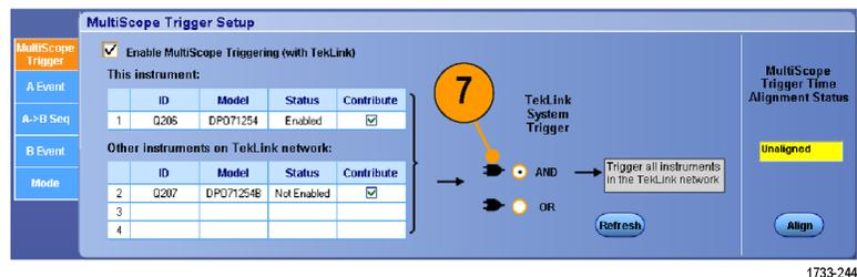
8. Чтобы синхронизировать запуск MultiScope, нажмите кнопку **Align**.
