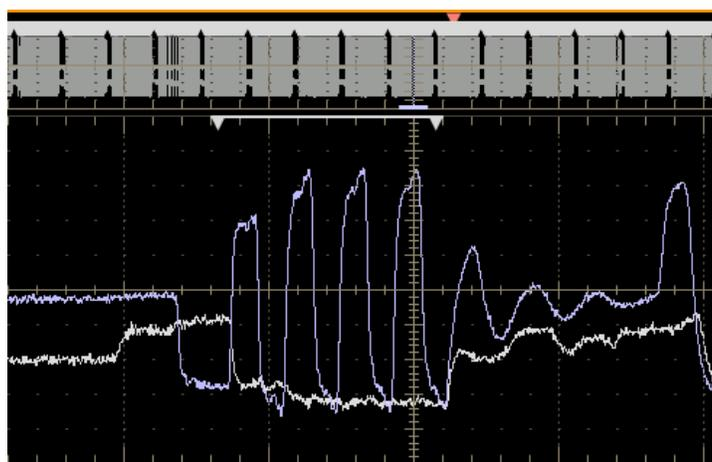
11. Для дальнейшего анализа DDR-сигнала нажмите кнопку **Next** под Select Measurements, чтобы перейти к DPOJET. Пакет расширенного анализа джиттера и глазковых диаграмм DPOJET позволяет измерять DDR-сигнал.
