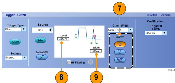
Установите флажок HF Filtering (фильтрация ВЧ), если требуется синхронизировать систему так, чтобы обрабатывать высокочастотную импульсную вспышку, как один импульс.
