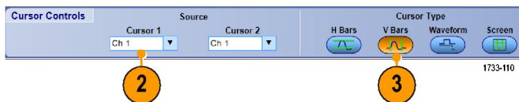
4. Если требуется выполнить измерения между двумя осциллограммами, выберите **Waveform**, а затем выберите источник сигнала для каждого курсора.
