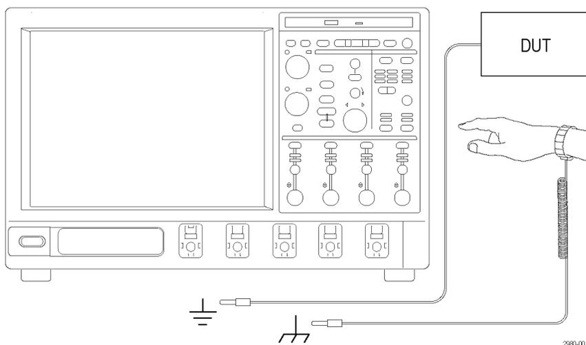
2. Кабель, оставленный неподсоединенным на рабочем столе, может собрать на себя большой статический заряд. Прежде чем подсоединять кабель к испытываемому прибору или устройству, снимите с него статическое напряжение путем кратковременного заземления центрального провода кабеля или подсоединения нагрузки в 50 Ом к одному из его концов.
