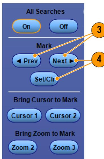
4. Нажмите кнопку **Set Clr** (установить, сбросить) или кнопку **Set/Clear** (установить/сбросить) на передней панели.
