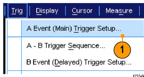
2. Задайте тип и источник синхронизации A на вкладке события A Event.
