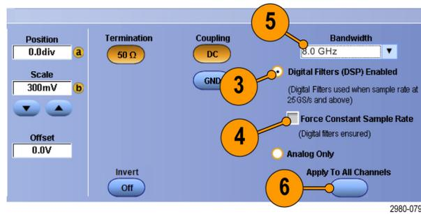
**ПРИМЕЧАНИЕ.** Если этот режим еще не установлен, то при выборе постоянной частоты выборки задается постоянная частота выборки для горизонтального режима, задается частота выборки, позволяющая использовать цифровую обработку, а также выбирается полоса пропускания DSP.
