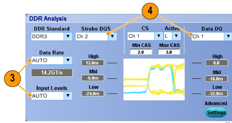
5. 或者選取晶片選取及晶片選取的使用中位準。晶片選取指定 DDR 測量的範圍。
