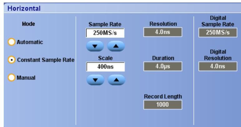
在「手動」模式下可以設定「取樣率」和「記錄長度」。根據取樣率和記錄長度計算出來的「水平刻度」是相依變數。
