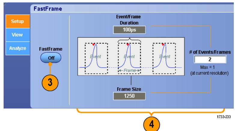
5. 使用 Frame Viewing (圖框檢視) 控制項來選取要檢視的圖框。
