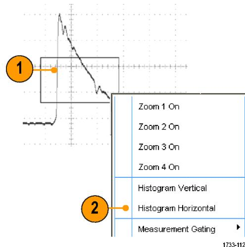
3. 在方格圖的頂點(可檢視水平長條圖)或左邊緣檢視長條圖(可檢視垂直長條圖)。
