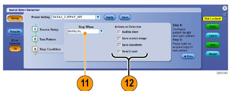
12. 選取並設定符合停止條件時要執行的動作。使用這些動作，即可保留示波器所擷取的資訊。您必須設定電子郵件地址和 SMTP 伺服器，才能讓「Send E-mail」(傳送電子郵件) 運作。
