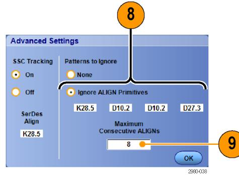
測試樣式設定可控制訊號測試樣式長度並提供同步樣式的說明。這些常是最困難的設定，因為使用者必須具備訊號的知識。樣式長度是訊號產生器或 AWG 傳送至 DUT 或示波器的位元數目。同步樣式是錯誤偵測器在訊號中使用的 10、20、30 或 40 位元特殊樣式，可將訊號和擷取的比較樣式對齊。
