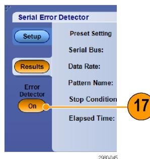
一般的啟動程序可歸納為 a) 選取預設設定；b) 按下「Sync」(同步)；c) 按下「Learn」(學習)(如果有此按鈕)；以及 d) 按下「Run」(執行)。同步操作可以讓示波器與訊號同步、學習操作可將訊號樣式擷取至示波器記憶體，而執行操作可啟動測試錯誤的錯誤偵測器。請注意，學習操作僅適用於部分的位元錯誤測試。請記住，圖框、符號和字元錯誤測試不需要學習操作。
