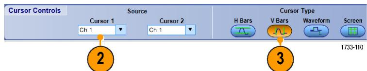
4. 如果要在二種波形之間進行測量，請選取 **Waveform** (波形)，再一一選取游標的波形來源。
