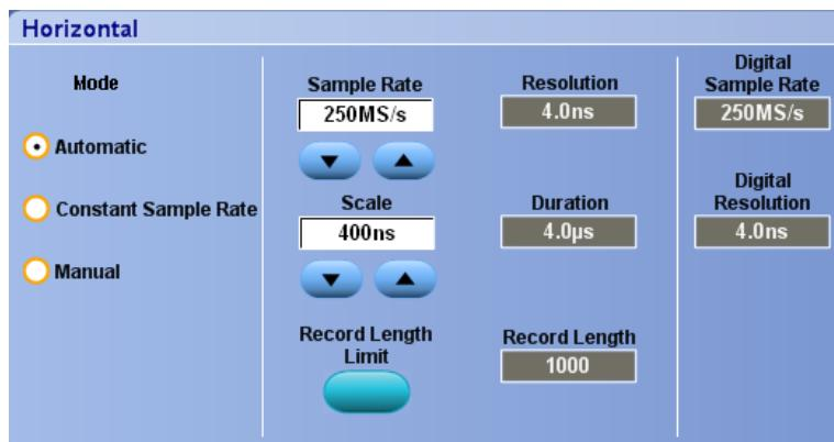
若要設定「記錄長度限制」，請按一下「Record Length Limit」(記錄長度限制)，並使用按鈕或鍵盤設定限制。預設的最大限制取決於儀器型號和記錄長度選項。
