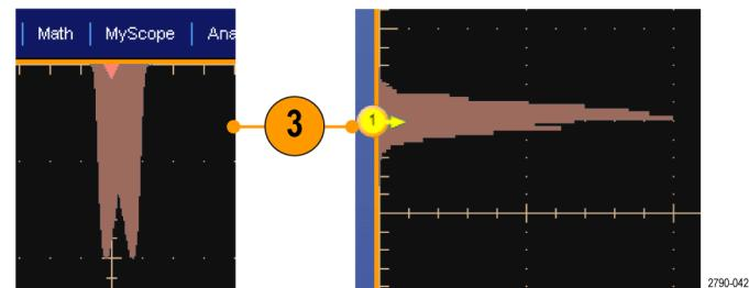
4. 如果要調整長條圖刻度、或長條圖矩形的尺寸和位置，請選取 Measure > Waveform Histograms (測量>波形長條圖)，再使用 Histogram Setup (長條圖設定) 控制視窗。
