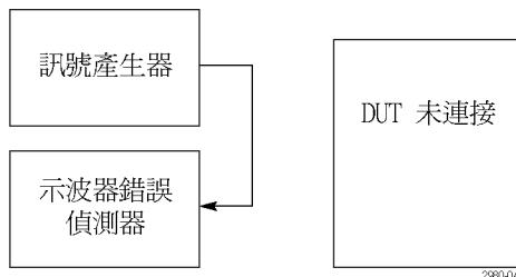
19. 完成學習操作後，現在您可以在如下圖所示的訊號產生器和錯誤偵測器之間插入 DUT。
