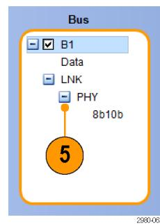
6. 按一下顯示器中的 + 或 - 方塊，也可新增或移除顯示器中的匯流排檢視。系統提供的檢視可能包括異動/傳輸、連結/圖框/封包、實體/位元組/符號和位元位準。
