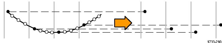
**Peak Detect (峰值檢)** 模式會使用兩個連續擷取間隔所含全部樣本中最高和最低者。這個模式只能用於即時、沒有任何插入的取樣，而且可以用來擷取高頻率突波。
