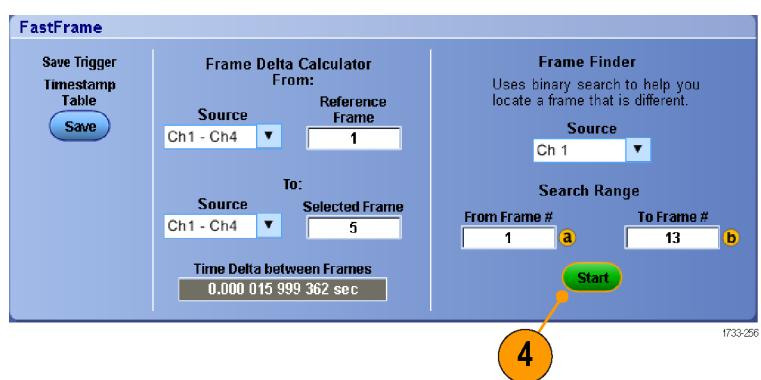
「圖框搜尋工具」能搜尋並顯示不同圖框。
