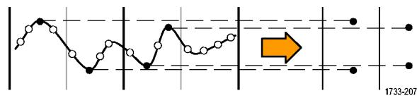
**Hi Res (高解析度)** 模式對所有擷取間隔計算其平均取樣值。「高解析度」模式提供較高解析度、較窄頻寬的波形。
