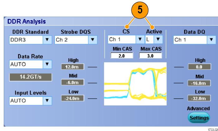
6. 按下 Advanced (進階) Settings (設定) 可自由設定晶片選取模式及位準、邊緣偵測磁滯現象及終端邏輯邊際：
