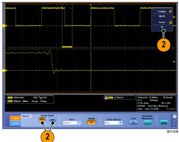
3. 如果要調整縮放方格圖尺寸，請從 Vertical (垂直) 或 Horiz/Acq (水平 / 摄取) 功能表選取 Zoom Graticule Size (縮放方格圖尺寸)。
