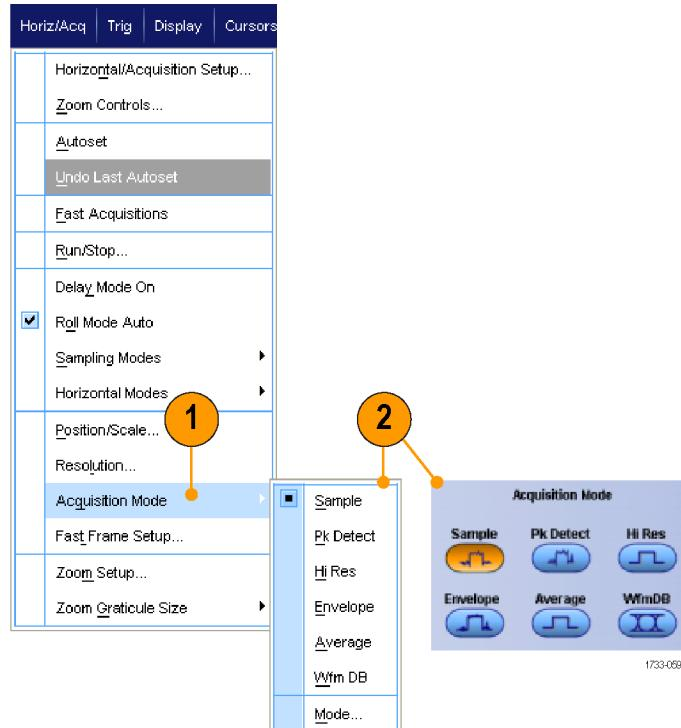
3. 使用 Average (平均) 或 Envelope (包封) 擷取模式時，請按一下「# of Wfms」(波形數目) 控制項，然後以多用途旋鈕設定波形數目。使用 WfmDB (波形資料庫) 模式時，請按一下「Samples」(取樣) 控制項，然後以多用途旋鈕設定取樣數目。
