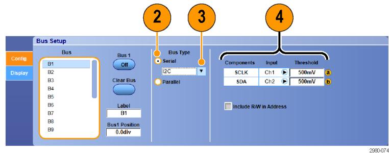
5. 選取「Trig > Bus Setup」(觸發 > 汇流排設定)。
