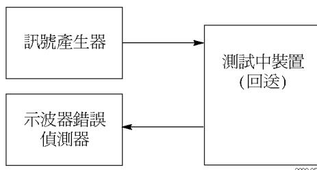
20. 如果要避免在學習操作之後重新排列纜線，可以分割訊號產生器的輸出，將某個分支放到錯誤偵測器，並將另一個放到 DUT。此案例已完成通道 1 的學習操作，但實際的錯誤偵測卻發生在通道 2。您可以調整訊號產生器的振幅，以說明因分割訊號造成的損失。這種方法可行，是因為錯誤偵測器的學習操作會將訊號測試樣式儲存至非特定通道的記憶體。
