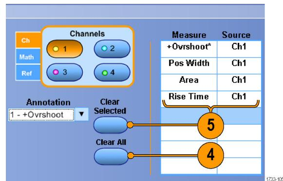
您也可以直接在 Measure (測量) 功能表選擇所選波形的測量值。(請參閱頁122，自動測量選項)
