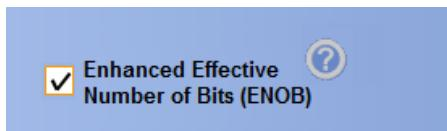
1. 按一下「Enhanced Effective Number of Bits」(加強型有效位元數) 核取方塊可開啟或關閉 ENOB 功能。您可在「Horizontal/Acquisition」(水平/擷取) 控制視窗的「Acquisitions」(擷取) 標籤中找到此控制項。
