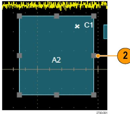
3. Klicken Sie mit der rechten Maustaste in den visuellen Triggerbereich und wählen Sie aus dem Menü Visual Trigger Area (Visueller Triggerbereich) aus.
