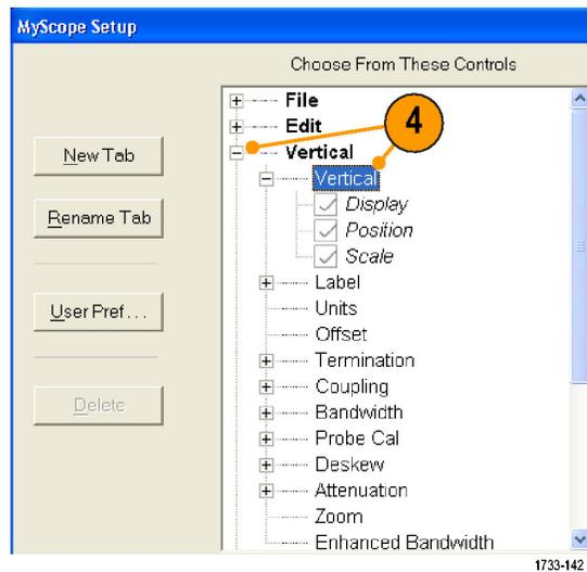
5. Deaktivieren Sie die Kontrollkästchen, um diejenigen Komponenten zu entfernen, die nicht zu dem Steuerelement gehören sollen.
