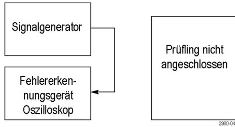
19. Nach Abschluss der Learn-Funktion können Sie den Prüfling zwischen dem Signalgenerator und dem Fehlererkennungsgerät schalten (siehe Abbildung).
