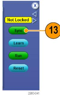
Beim Sync-Vorgang wird das Oszilloskop mit dem Signal synchronisiert.
