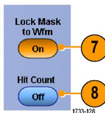
8. Schalten Sie **Hit Count On** (Trefferzählung AN) an oder aus, um Verstöße während eines Maskentests hervorzuheben.
