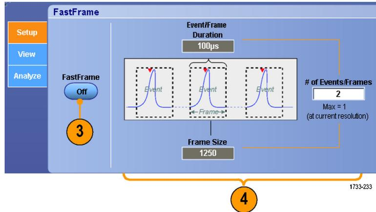
5. Wählen Sie mithilfe der Steuerelemente „Frame Viewing“ (Frameanzeige) den Rahmen aus, der angezeigt werden soll.
