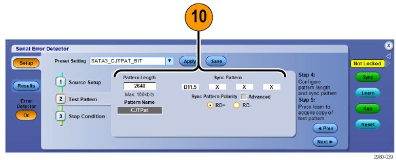
11. Wählen Sie unter der Registerkarte Stop Condition (Stoppbedingung) die Bedingung Stop When (Stoppen bei) aus. Für das Stoppen stehen folgende Alternativen zur Auswahl: manuell, bei einem bestimmten Zählerstand oder nach Ablauf einer von Ihnen angegebenen Frist.
