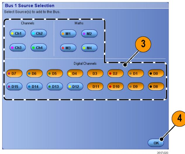
5. Um einen Kanal innerhalb eines Busses zu verschieben, blättern Sie zu dem entsprechenden Kanal, wählen Sie diesen aus, und klicken Sie anschließend auf die Schaltflächen mit dem Pfeil nach oben bzw. nach unten.
