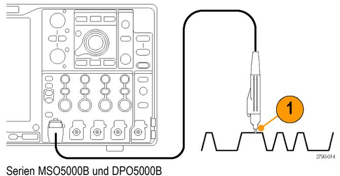
2. Wählen Sie den Eingangskanal durch Drücken der Tasten auf dem vorderen Bedienfeld aus. Dadurch werden die Kanäle ein- und ausgeschaltet.
