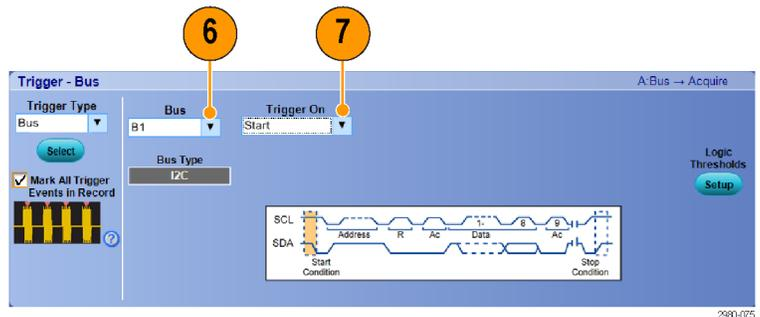
8. Je nach Einstellung von **Trigger On** (Trigger Ein) müssen Sie möglicherweise noch weitere Auswahlen vornehmen.
