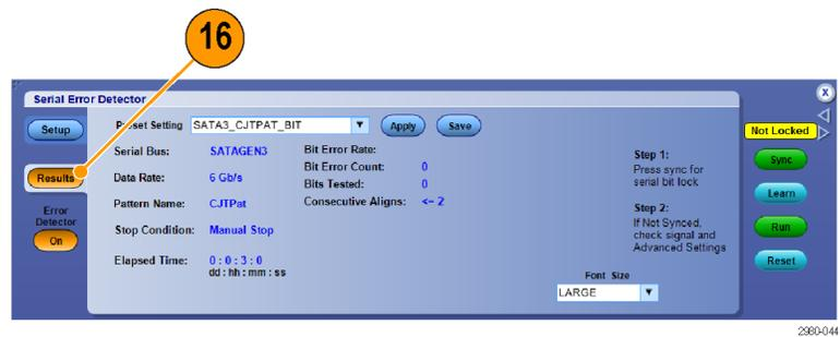
Wenn Sie eines der bereits vorgegebenen AWG-Signalmuster verwenden, können Sie eine Funktionsprüfung der Fehlererkennung vornehmen, indem Sie die Taste **Force Event** (Ereignis erzwingen) auf dem AWG drücken, um einen Fehler im Signal zu erzeugen. Unter Windows 7 befinden sich diese AWG-Setup-Dateien im Verzeichnis C:\User\Public\Tektronix\Tekscope>ErrorDetector\AWG.
