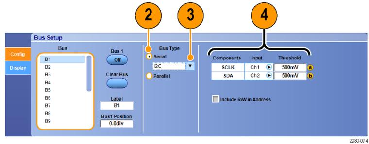
5. Wählen Sie Trig > Bus Setup (Trigger > Buseinstellungen).
