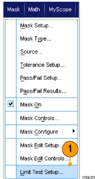
2. Erstellen Sie eine Toleranzmaske, indem Sie die Quelle, das Ziel und die Toleranzen auswählen. Die Toleranzen werden mit dem Mehrweckknopf eingestellt. Toleranzen geben den für das Signal zulässigen Grenzwertbereich an, bevor der Grenzwertest fehlschlägt.
