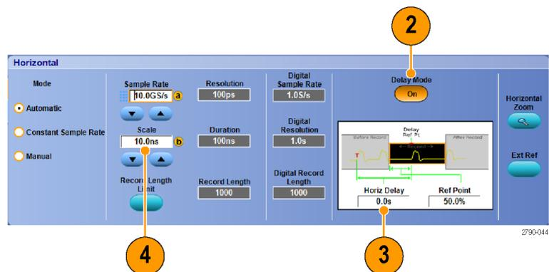
4. Mit dem Steuerelement **SCALE** (Skala) für die Horizontalskala können Sie die erforderliche Detailanzeige erzielen.
