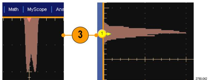
4. Um Anpassungen an der Histogrammskalierung oder an der Größe und Position des Histogrammfeldes vorzunehmen, wählen Sie **Measure > Waveform Histograms** (Messung > Signalhistogramme) aus, und verwenden dann das Steuerungsfenster Histogram Setup (Histogramm-Einstellung).
