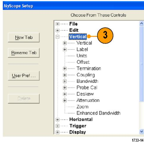
4. Doppelklicken Sie auf das Steuerelement, oder klicken Sie auf das +, um die Liste der Steuerelemente einzublenden. (Falls kein + vorhanden ist, kann das Steuerelement nicht mehr verwendet werden).
