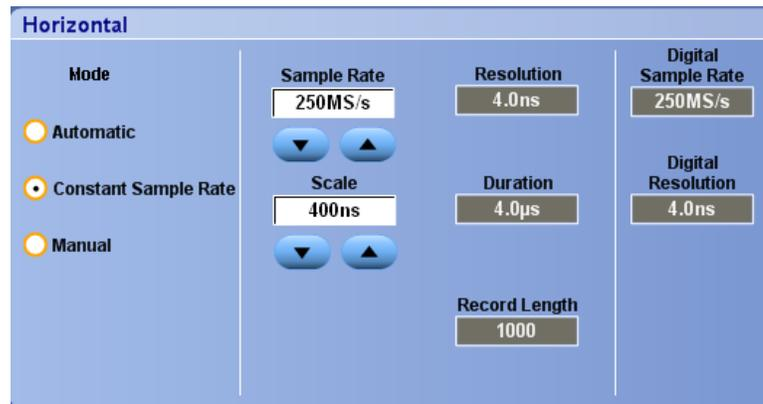
Im Modus Manual (Manuell) können Sie die Abtastrate und die Aufzeichnungslänge festlegen. Die horizontale Skala ist eine abhängige Variable, die aus Abtastrate und Aufzeichnungslänge berechnet wird.
