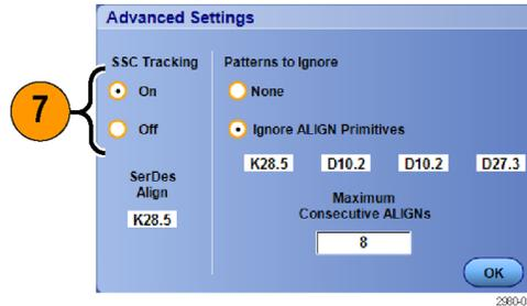
8. Zum Vermeiden von Ausrichtungsgrundelementen klicken Sie auf die Optionstaste **Ignore Align Primitives** (Ausrichtungsgrundelemente ignorieren) und geben Sie über das Tastenfeld oder die Tastatur die entsprechenden Grundelemente an.
