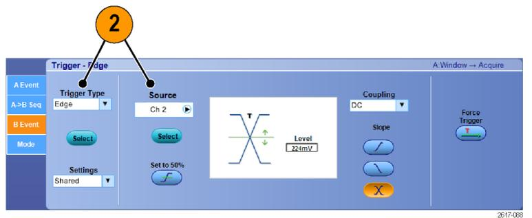
3. Zum genaueren Platzieren des Triggers auf der Anzeige aktivieren Sie **Enhanced Triggering** (Verbesserte Triggerung). Um den Trigger exakter auf Störsignalen zu positionieren, aktivieren Sie auch die Option **Optimized for Noisy Signals** (Optimiert für Störsignale).
