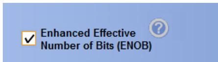
1. Klicken Sie auf das Kontrollkästchen **Enhanced Effective Number of Bits** (Erweiterte effektive Bitanzahl), um ENOB zu aktivieren oder zu deaktivieren. Sie finden diese Steuerung in der Registerkarte „Acquisition“ (Erfassung) im Steuerungsfenster „Horizontal/Acquisition“ (Horizontal/Erfassung).
