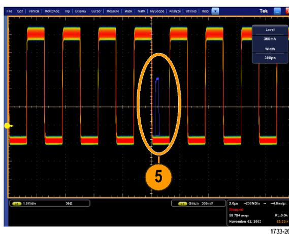
6. ステップ 5 で特定したグリッチでトリガするために、**Glitch Setup...** を選択します。
