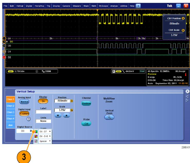
4. バスに取り込むアナログ波形のデジタル変換にチャンネルのスレッシュホールドを設定するには、**Logic Properties** ボタンをクリックします。
