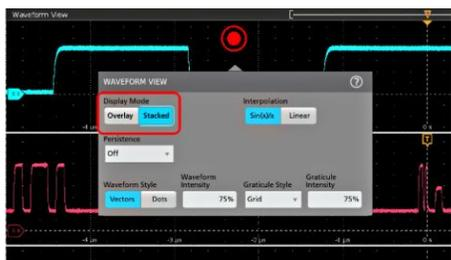
2. Для переключения между режимами **Overlay** (Наложение) и **Stacked** (Стековый) коснитесь кнопки **Display Mode**.
