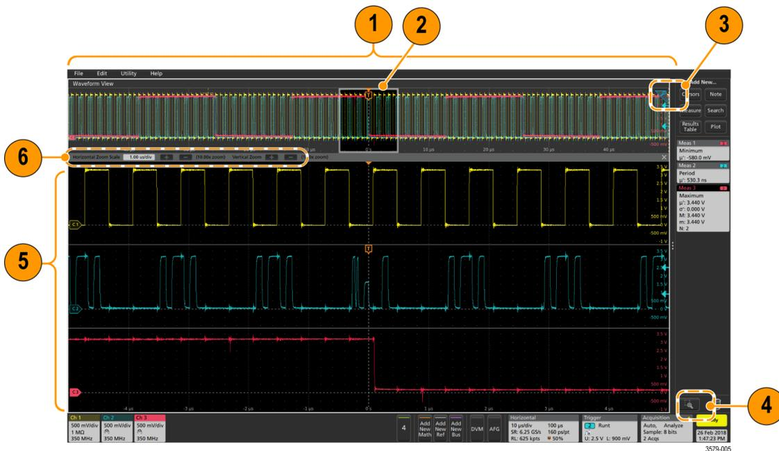
1. На панели **Zoom Overview** (Обзор масштабирования) отображается вся запись осциллограммы. В области **Zoom Overview** (Обзор масштабирования) все сигналы представлены в режиме наложения.
