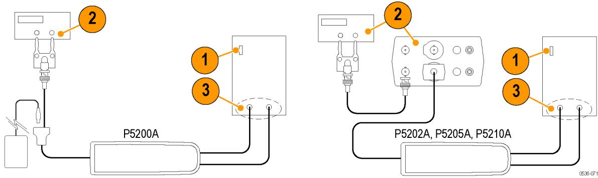
3. プローブ入力をゼネレータ前面の出力に接続します。DMM を AC 電圧に設定します。
