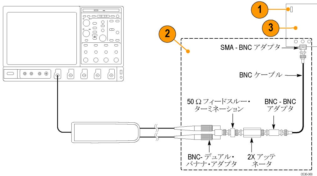
3. パルス・ゼネレータの出力を 50 V、1 KHz、および 200 ns のパルス出力に設定します。(プローブの入力電圧は回路中の 2X アッテネータにより 25 V になります。)
