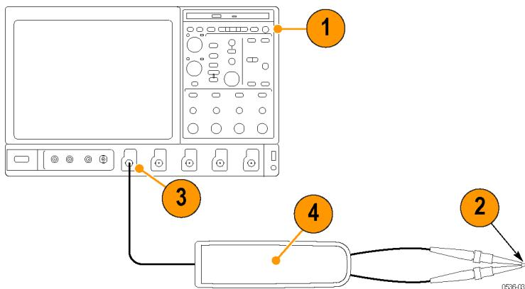
3. このステップはP5202A型、P5205A型、およびP5210A型プローブのみに適用されます。絶縁された調整ツールを使用して、プローブの補正ボックス内のOFFSET ADJUST ポットを中央に合わせます。
