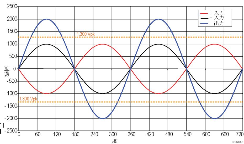
\*振幅が同一で位相が  $180^\circ$  度ずれた正弦波形がこれらの電圧を超えると、最大差動定格を超えることとなり、波形のクリッピング、測定確度の誤差、また感電と火災の危険が増大する結果となります。
