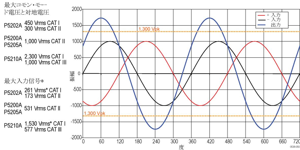
図 3:  $120^\circ$  度位相のずれた等振幅の 2 つの波形の測定
