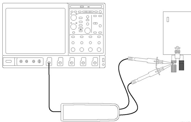
3. ゼネレータの正弦波出力を表に示す電圧と周波数に設定します。(51 ページの 表 17 参照)。
