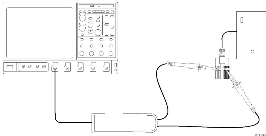
3. プローブの減衰比を、調整するプローブの低い方のレンジに設定します。
