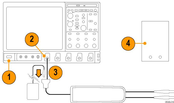
4. ゼネレータの電源を入れ、プローブとテスト機器を 20 分間ウォーム・アップします。
