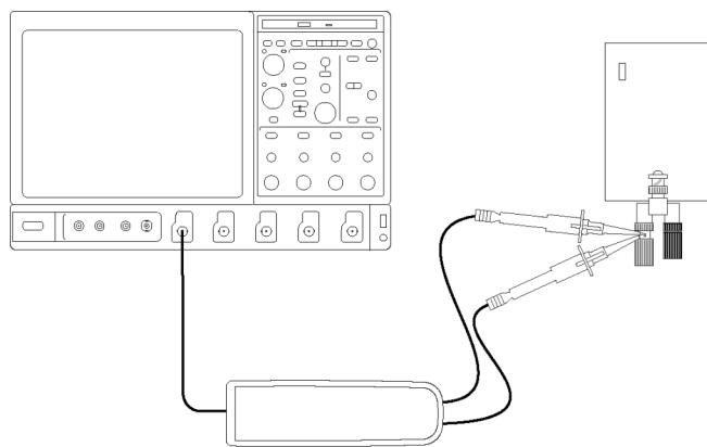
3. ゼネレータの正弦波出力を 297 Vp-p (105 Vrms) @100 KHz に設定します。
