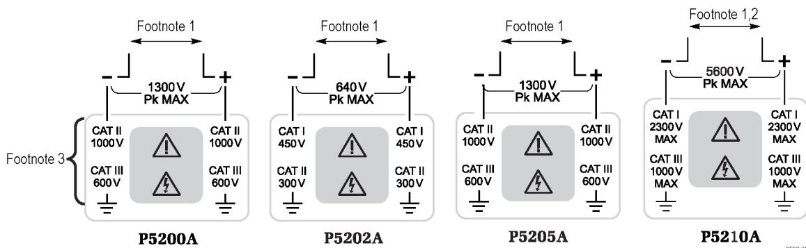
図 4: 各プローブ・ラベルに表示されている、表中のプローブの入力限度仕様に関する脚注
