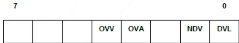
**位元 4 - OVV:** 設定此位元以表示電壓範圍超載。當範圍超載狀況解除時，系統會自動清除此位元。
