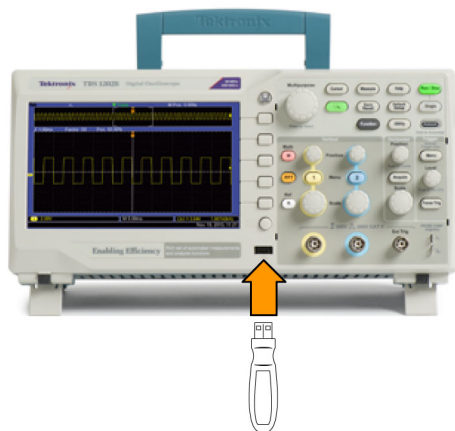
图 28: 将包从 USB 存储设备导入 TBS1000B-EDU 示波器
