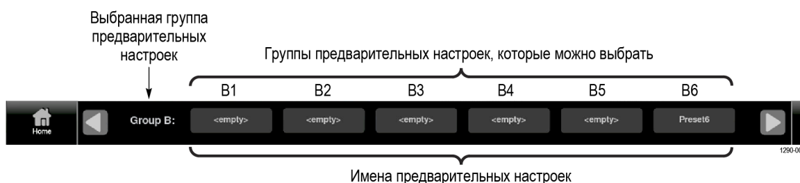
Рис. 23: Элементы управления выбором набора предварительных настроек (выбрана группа B)
