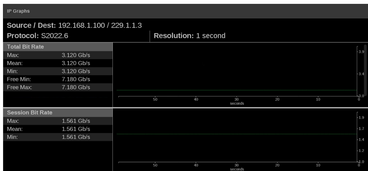
Рис. 51: Приложение IP Graphs — диаграммы суммарной скорости и скорости сессии
