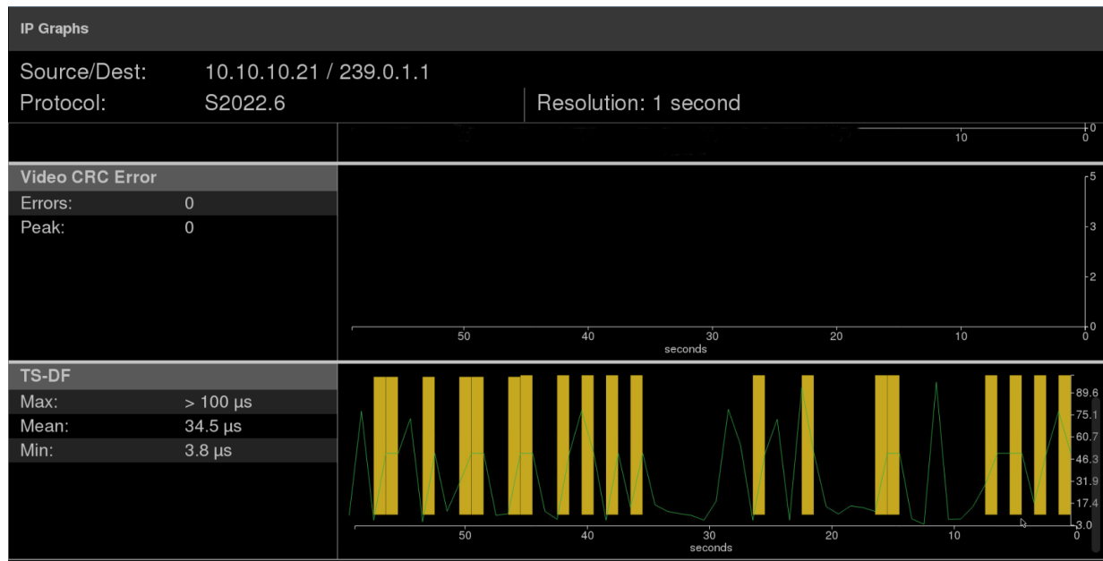
Рис. 53: Диаграммы Video CRC Error и TS-DF приложения «IP Graphs»
