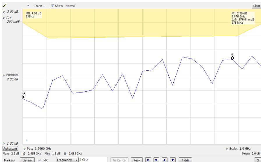
下图显示了失败噪声系数在模板之外且已启用“下部模板”和“上部模板”的测试的结果。红色区域突出显示失败区域，它们在下部模板中发生。也使用了标记。
