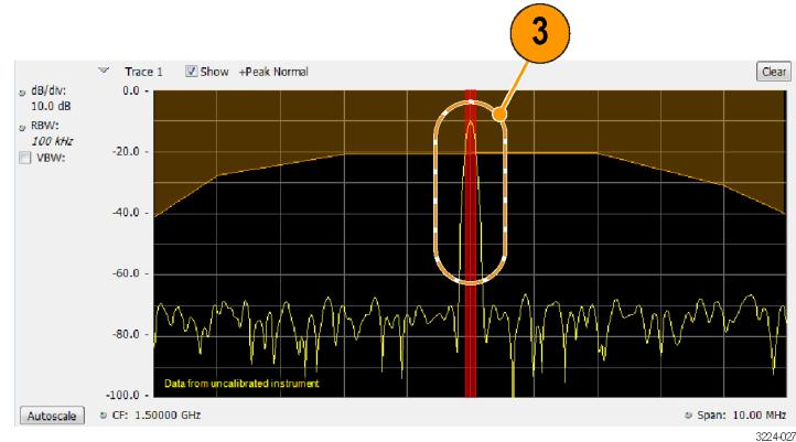
**执行外部/内部模板测试:** 如果您指定基于模板的测试，那么您需要编辑模板以指定违例水平。您可按照以下方法来完成。
