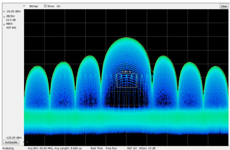
如果预计信号是一个连续音调，并且希望在其跳到其他频率或下降到一个较低幅度时捕获相应事件，请将 Density (密度) 测量框移到信号峰值处，在 Density (密度) 控件中选择 Lower (低于)，并将 Threshold (门限) 设置为 100%。当信号不在该测量框中时，仪器将触发。
