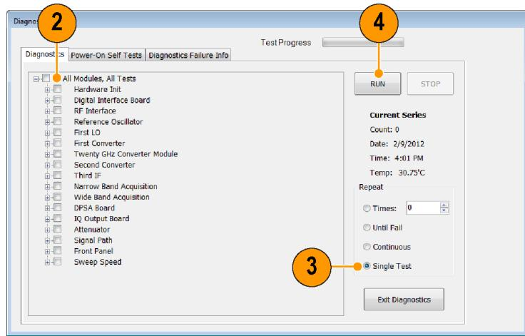
**说明：**选择 Diagnostics Failure Information（诊断故障信息）选项卡可查看基本的诊断故障信息。用 Windows 的“事件查看器”（Control Panel（控制面板）> System and Security（系统和安全）> Administrative Tools（管理工具）> Event Viewer（事件查看器）可查看应用程序报告的故障历史和非诊断故障。
