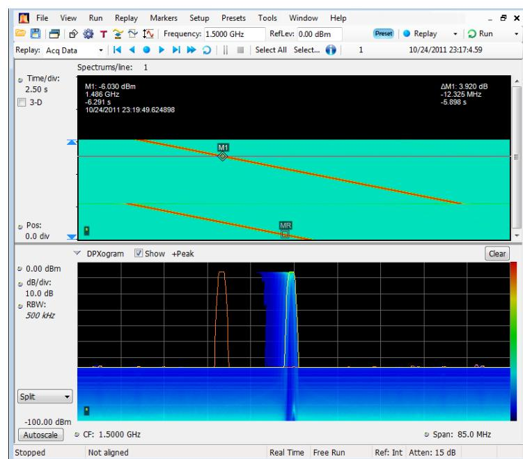
此示例展示了含有两个显示（Spectrum（频谱）显示和 DPX Spectrum（DPX 频谱）显示）的窗口。
