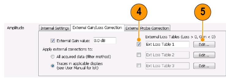
6. 编辑表的内容，使其符合所校正的设备的损耗特性。完成后单击 **OK (确定)**。
