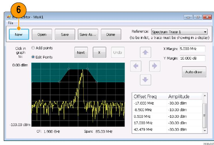
7. 单击模板中的任何点以选择该点。选定点的频率和幅度会加亮显示在图形中。
