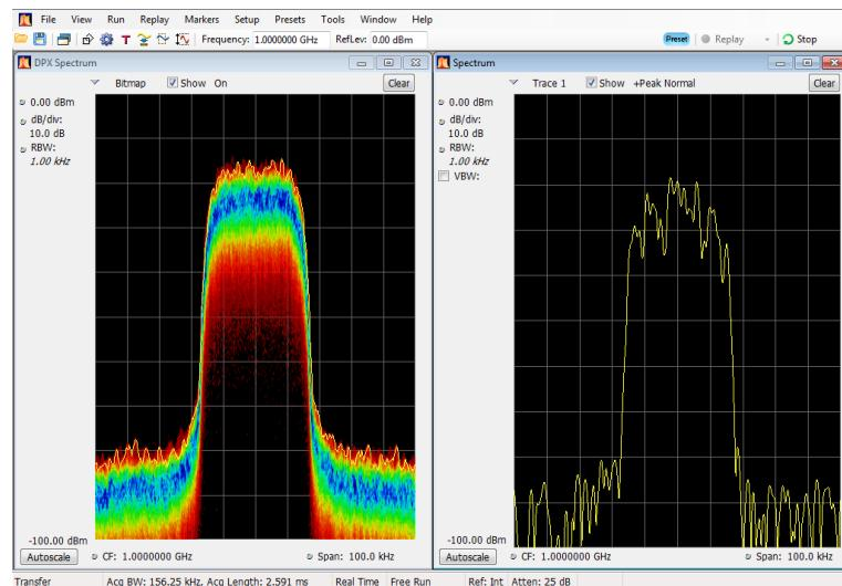
某些显示不能控制采集硬件。这些显示仅显示捕获的数据。某些显示可共享相同的参数。如果它们中的任何一个显示控制采集硬件，则为它们中的所有显示优化采集参数。
