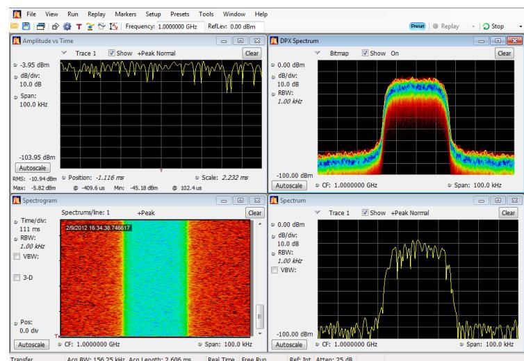
采集数据源可以是实时采集，也可以是已保存的采集数据文件。在显示之间共享采集数据，可以多种方式查看相同的数据。例如，您可同时显示功率与频率（频谱）关系显示和频谱图显示。因为数据源在各个显示之间是共享的，因此这些显示是相关的。也就是说，一个显示中的一个点或一组点与应用程序窗口中任何其他显示中的一个点或一组点相关联。
