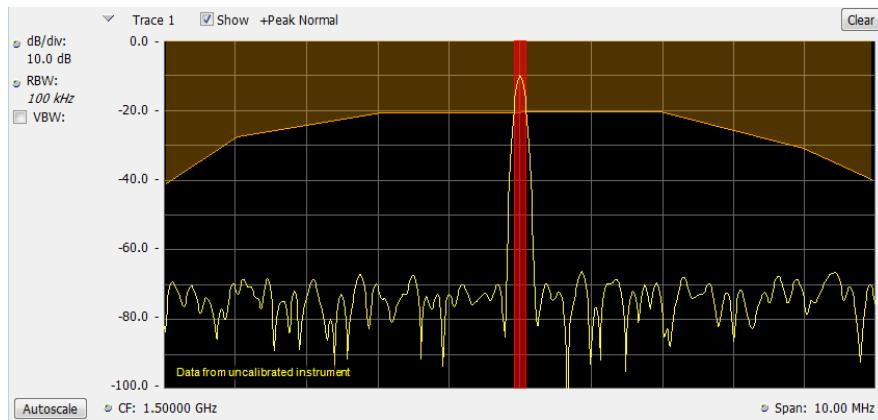
次の図は、Upper Mask を有効にした **is outside mask** ノイズ・フィギュア・テストに合格した例を示しています。マーカも使用されています。
