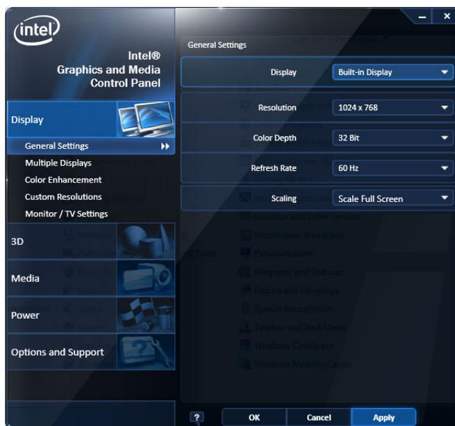
注：推奨はできませんが、アナライザの電源をオンにした後で外部モニタを接続することもできます。ただし、接続後、Intel Extreme Graphics 2M のコントロール・パネルで Extended Desktop を有効にする必要があります。
