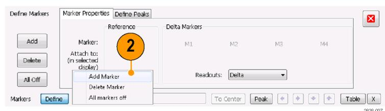
3. Marker ツール・バーの矢印ボタンを使用して、スクリーンのマーカを移動します。タッチ・スクリーンまたはマウスを使用して、マーカを目的の位置にドラッグすることもできます。
