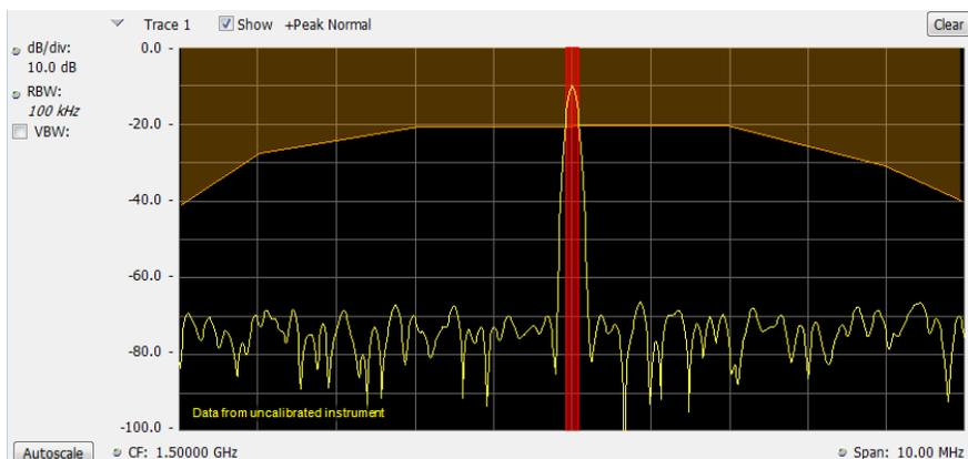
次の図は、Uper Mask を有効にした **is outside mask** ノイズ・フィギュア・テストに合格した例を示しています。マーカも使用されています。
