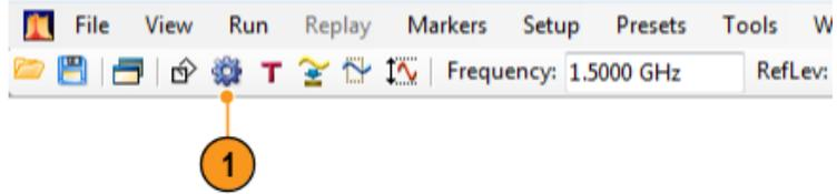
2. 使用する信号またはテストに必要なコントロールを調整します。たとえば、周波数とスパンを設定するには Freq & Span タブを使用します。コントロール・パネルのほとんどに、他の関連するコントロールに簡単にアクセスできるタブがあります。(33 ページ「ヒント」参照)。
