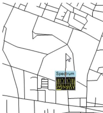
矢印を描くに伴い、RSA Map 測定サムネイルに矢印の方向が表示されます。表示には、真方位と磁針方位が示されます。矢印の方向を変えると、サムネイルに表示される角度が更新され、これを見ながら方向を正確に設定することができます。表示される情報は、地図の種類により異なります(ジオリファレンスか、またはイメージ)。ここに示す例は、ジオリファレンス地図のものであります。
