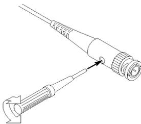
4. 必要に応じて、プローブを調整します。必要に応じて手順を繰り返します。
