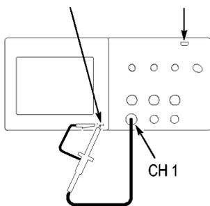
1. 1 ▶ Probe (プローブ) ▶ Voltage (電圧) ▶ Attenuation (減衰) オプションを押し、10X を選択します。TPP0101 および TPP0201 型プローブをオシロスコープのチャンネル 1 に接続します。プローブ・フックチップを使用する場合は、チップをプローブにしっかり差し込んで取り付け、適切に接続されていることを確認してください。
