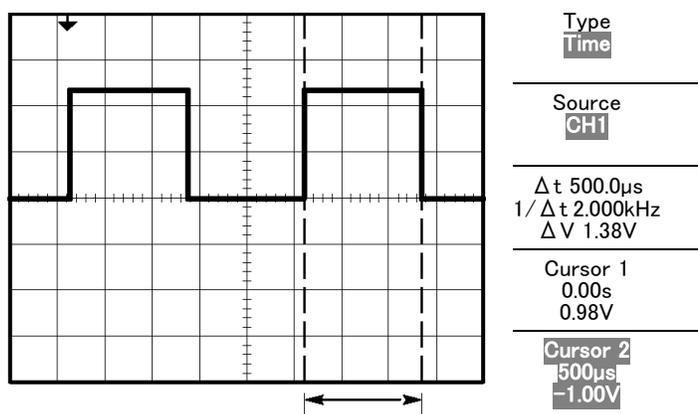
**注:** Measure Menu (波形測定メニュー) の自動測定として正のパルス幅測定を実行できます。(94 ページ「測定の実行」参照)。
