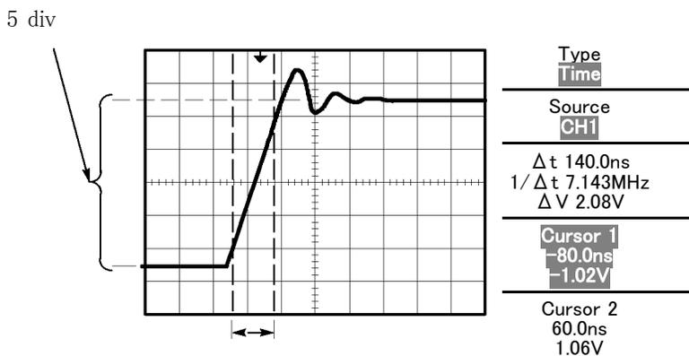
**注:** Measure Menu (波形測定メニュー) の自動測定として立上り時間測定を実行できます。(94 ページ「測定の実行」参照)。
