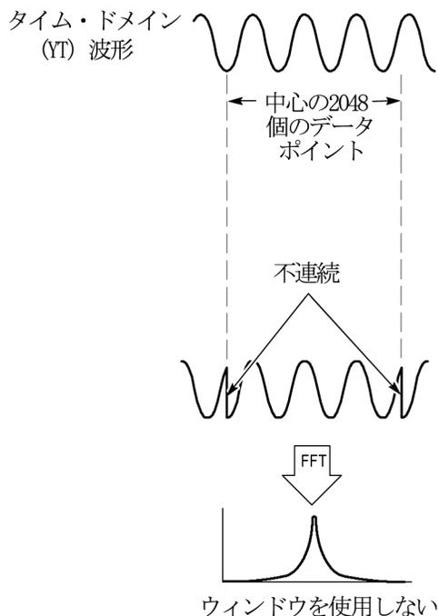
YT 波形にウィンドウを適用すると、振幅が変化して開始と終了の値が近づき、不連続の発生を抑えることができます。
