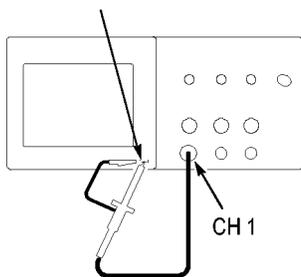
2. TPP0101 または TP0201 型プローブをオシロスコープのチャンネル 1 に接続します。接続するには、プローブのコンネクタのロットと CH 1 BNC のキーを揃えて押し込み、右に回して固定します。
