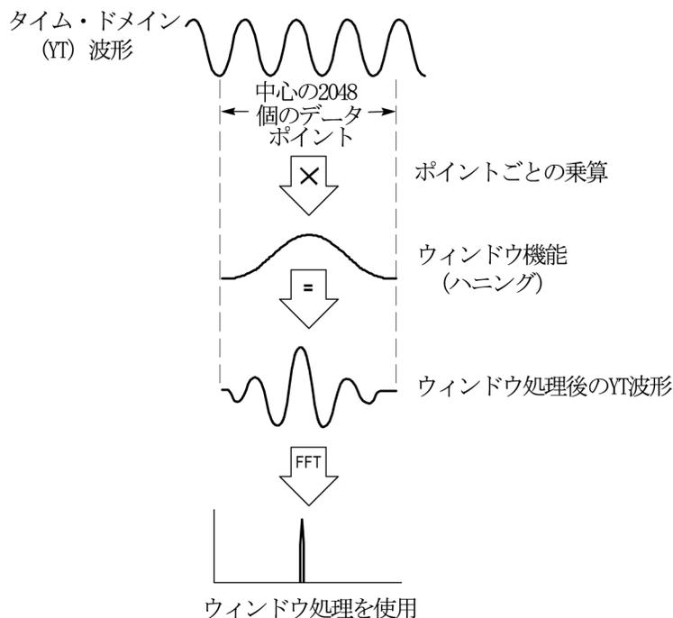
FFT 演算機能には、3 種類の FFT ウィンドウ・オプションが用意されています。各種類のウィンドウは、周波数分解能と振幅精度の点で相反する性質を持っています。測定する項目やソース信号の特性によって、どのウィンドウを使用するかを決定します。
