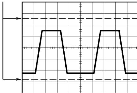
**カーソル** この方法で測定するには、常に対になって表示されているカーソルを移動し、ディスプレイのリードアウトから数値を読み取ります。カーソルには、振幅カーソルと時間カーソルの 2 種類があります。
