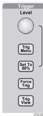
**Level (レベル):** エッジ・トリガまたはパルス・トリガを使用しているときには、Level (レベル) ノブは、波形を取り込むために信号を超える必要のある振幅レベルを設定します。
