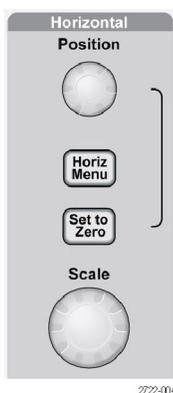
**Position (位置):** すべてのチャンネルおよび演算波形の水平位置を調整します。このコントロールの分解能は、時間軸の設定によって異なります。(92 ページ「Window Zone (範囲指定)」参照)。
