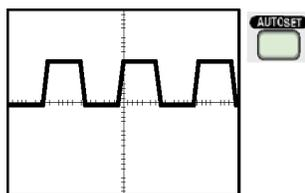
3. **AUTOSET** (オートセット) ボタンを押します。数秒以内に、約 5V p-p、周波数 1 KHz の方形波がディスプレイに表示されます。フロント・パネルの **1** (チャンネル 1 メニュー) ボタンを 2 回押してチャンネル 1 を消去し、**2** (チャンネル 2 メニュー) ボタンを押してチャンネル 2 を表示します。次に、手順 2 と手順 3 を繰り返します。4 チャンネル・モデルの場合は、チャンネル **3** と **4** について手順を繰り返します。
