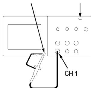
1. 按下「**1 ▶ 探棒 ▶ 電壓 ▶ 衰減**」選項，並選取「**10X**」。將 TPP0101/TPP0201 探棒連接至示波器上的波道 1。如果您使用探棒勾頭，勾頭要確實插入探棒，以確保連接正常。
