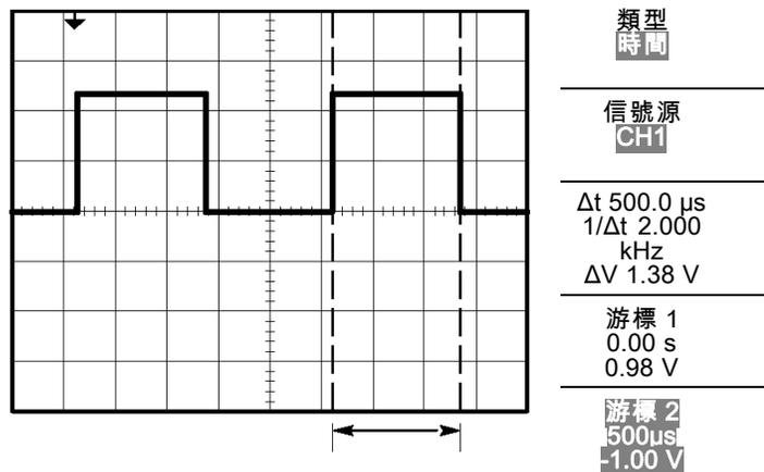
**注意。** 您也可以使用「測量功能表」中的自動測量來取得「正脈波寬度」測定。(請參閱頁83，*進行測量*)
