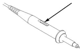
**注意。** 當「衰減切換」設定為 1X 時，P2200 探棒會將示波器頻寬限制在 6 MHz。若要使用示波器全頻寬，請確定將設定切換到 10X。
