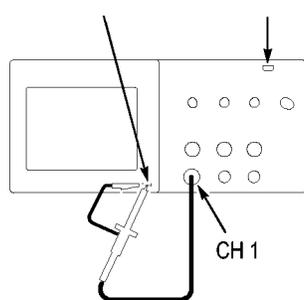
1. 按下「1 ▶ 探棒 ▶ 電壓 ▶ 衰減」選項，並選取「10X」。將 TPP0101/TPP0201 探棒連接至示波器上的波道 1。如果您使用探棒勾頭，勾頭要確實插入探棒，以確保連接正常。
