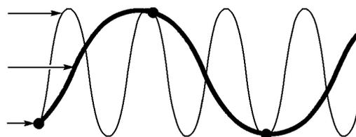
示波器能準確地還原訊號，但只限於使用探棒頻寬、示波器頻寬和取樣率。若要避免假像發生，則示波器的取樣率必需高於兩倍待測訊號的最高頻率分量的速度。
