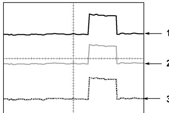
1. 實線波形表示波道 (顯示中) 的波形顯示。如果沒有任何控制發生變更，而致使顯示的精確度變的不確定，那麼當擷取停止時波形會保持實線。您可以在停止擷取後變更垂直和水平控制。
