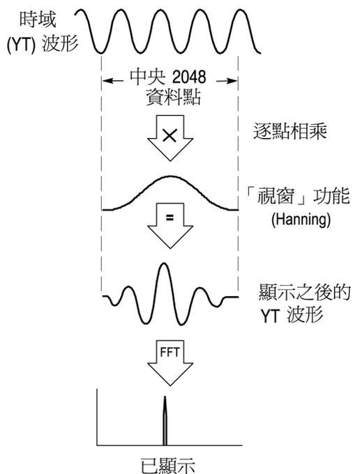
數學 FFT 函數包括了三個「FFT 視窗」選項。每種視窗類型必須要在頻率解析度和振幅精確度間加以取捨。您要測量的目標、以及信號源訊號特性，都會影響您決定該使用哪個視窗。
