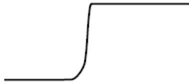
使用短接地导线的信号
