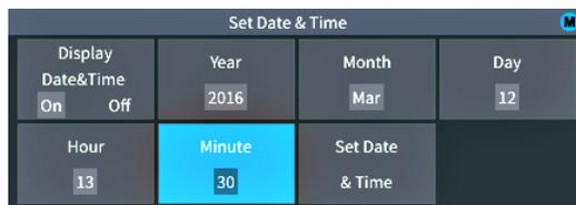
7. 完成所有日期和时间更改后，旋转通用旋钮以选择**设置日期和时间**，然后单击该旋钮为示波器输入日期/时间设置。
