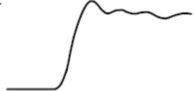
使用长接地导线的信号
