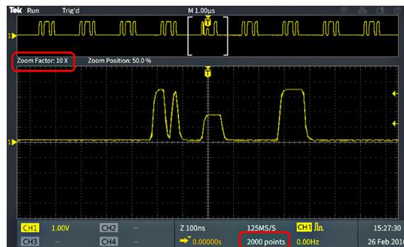
Signaldatensatz mit maximaler Zoom-Einstellung, erfasst mit 2000 Punkten
