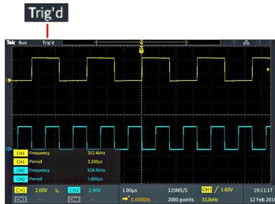
3. Das Triggerpositionssymbol (T) gibt an, wo der Trigger im Signaldatensatz aufgetreten ist.
