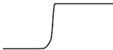
Signal mit einem kurzen Erdungsleiter
