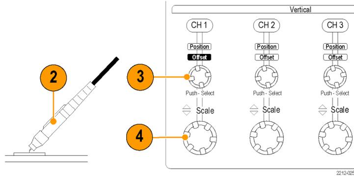
**说明：** 探头的差分输入范围为 2.0 V<sub>p-p</sub>，在工作输入电压范围 +5 V 至 -4 V 之上。偏置范围为 +1 V 至 -1 V。
