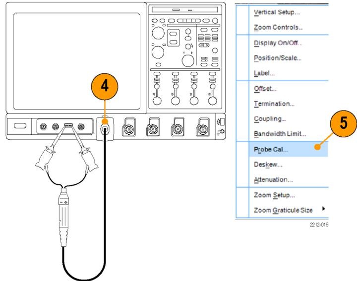
6. 出现 Probe Setup (探头设置) 屏幕后, 选择 **Clear ProbeCal (清除探头校准)**, 然后选择 **Calibrate Probe (校准探头)**。探头校准例程即会开始。例程完成后, Probe Status (探头状态) 从 Running (正在运行) 变成 Pass (通过)。关闭通知程序并开始使用探头。
