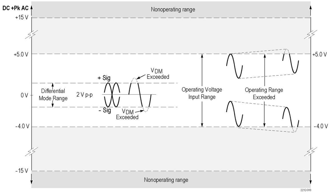
图 1: 无直流偏置的输入电压限制
