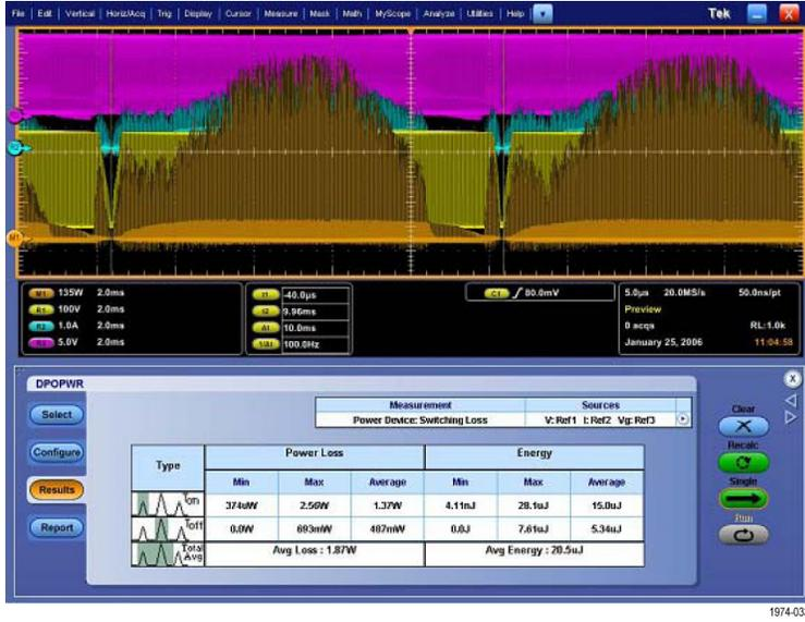
图 3: 开关损耗结果显示
