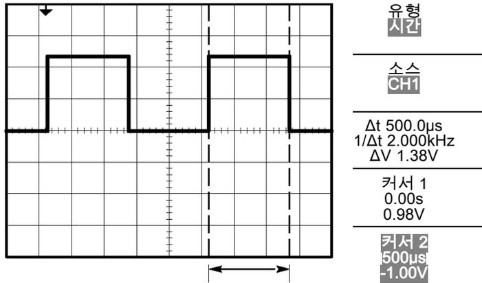
**주석노트.** 상승 펄스 측정은 측정 메뉴에서 자동 측정으로 사용할 수 있습니다. (81페이지의 측정 참조)
