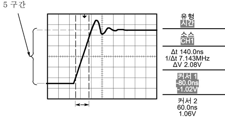
**주석노트.** 상승 시간 측정은 측정 메뉴에서 자동 측정으로 사용할 수 있습니다. (81페이지의 측정 참조)
