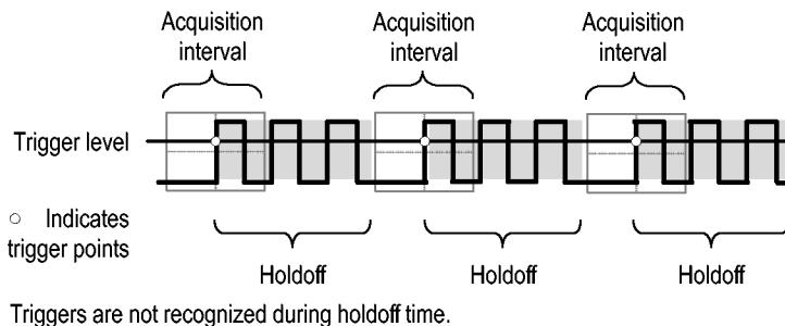
若要使用「觸發延滯」，請按下「Horiz ▶ Set Trigger Holdoff」（水平▶設定觸發器 Holdoff）選項按鈕並使用多功能旋鈕來調整延滯。觸發延滯的解析度會隨著水平刻度設定變化。
