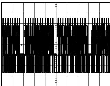
**注意。** 大部分視訊系統都使用 75 ohm (歐姆) 的電纜配線。示波器輸入無法正常中止低阻抗的電纜配線。為避免因不正常的負載和反射產生錯誤的振幅，請將 75 ohm feedthrough 終端器 (Tek PN 011-0055-02 或同等級產品) 置於從訊號源到示波器 BNC 輸入的 75 ohm 同軸電纜間。
