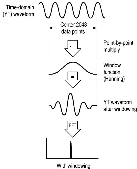
數學 FFT 函數包括了三個「FFT 視窗」選項。每種視窗類型必須要在頻率解析度和振幅精確度間加以取捨。您要測量的目標、以及信號源訊號特性，都會影響您決定該使用哪個視窗。
