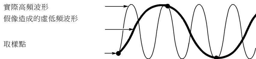
示波器能準確地還原訊號，但只限於使用探棒頻寬、示波器頻寬和取樣率。若要避免假像發生，則示波器的取樣率必需高於兩倍待測訊號的最高頻率分量的速度。
