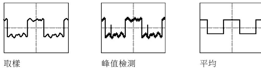
**取樣：**使用「取樣」擷取模式可擷取 2500 個點，並依水平刻度 (秒/格) 設定來顯示這些點。「取樣」模式為預設模式。
