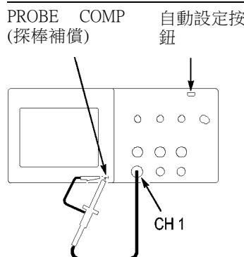
1. 按下「1 ▶ 探棒 ▶ 電壓 ▶ 衰減」選項，並選取「10X」。將 TPP0101/TPP0201 探棒連接至示波器上的波道 1。如果您使用探棒勾頭，勾頭要確實插入探棒，以確保連接正常。
