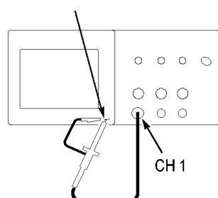
2. 將 TPP0101/TP0201 探棒連接至示波器上的波道 1。若要執行此動作，請將探棒接頭插槽對齊 CH 1 BNC 鎖並插入以連接，並向右扭轉以鎖定探棒。
