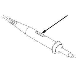
**注意。** 當「衰減切換」設定為 1X 時，P2220 探棒會將示波器頻寬限制在 6 MHz。若要要使用示波器全頻寬，請確定將設定切換到 10X。
