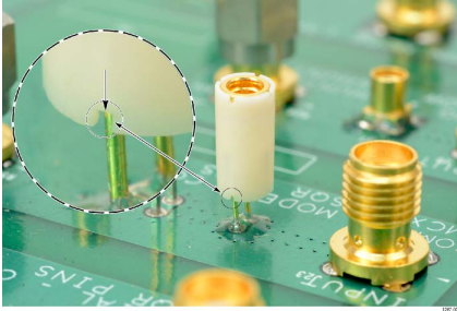
图17: 对齐MMCX到0.062英寸(1.57毫米)适配器与电路板
