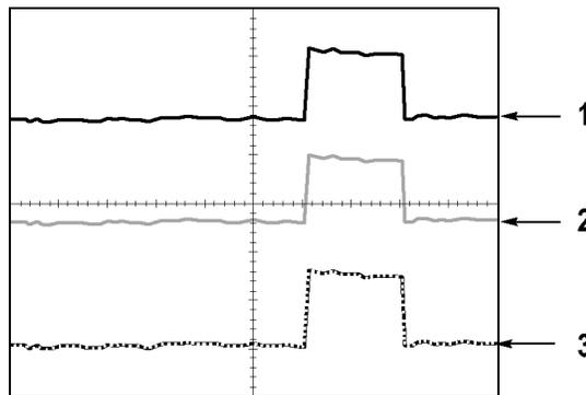
1. 连续波形表示一个通道的（活动的）波形显示。如果没有改变使显示精度不确定的控制，则停止波形采集时波形保持连续。
