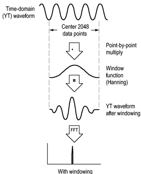
“数学计算 FFT”功能有三个“FFT 视窗”选项。对于每种类型的视窗，在频率分辨率和幅度精度之间都会有所取舍。要测量的项目和源信号特性可用于确定要使用哪一种视窗。
