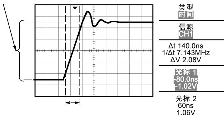
**说明：**“上升时间”测量可作为 Measure（测量）菜单中的自动测量。（见第100页，*测量*）
