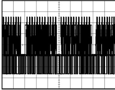
**说明：**多数视频系统使用 75 欧姆电缆线路。示波器输入端不能直接端接到低阻抗电缆上。要避免由于负载不当和因反射而引起的幅度误差，可在信号源的 75 欧姆同轴电缆与示波器 BNC 输入之间放置一个 75 欧姆的馈通终接器（Tektronix 部件号 011-0055-02 或同类产品）。
