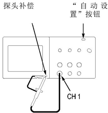
1. 按下通道 1 “Menu（菜单）” ▶ “探头” ▶ “电压” ▶ “衰减” 选项并选择 10X。将探头连接到示波器的通道 1 上。如果使用探头钩式端部，请确保钩式端部牢固地插在探头上。
