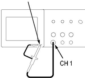
2. 将探头连接到示波器的通道 1 上。要进行此操作，请将探头连接器上的插槽对准通道 1 BNC 上的凸键，按下即可连接，然后向右转动将探头锁定到位。
