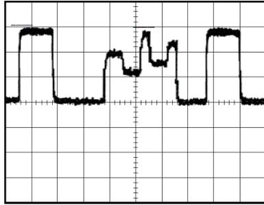
**说明：** 触发频率读数显示示波器可能认为是一个触发器的事件的频率，并可能小于脉冲宽度触发模式下输入信号的频率。
