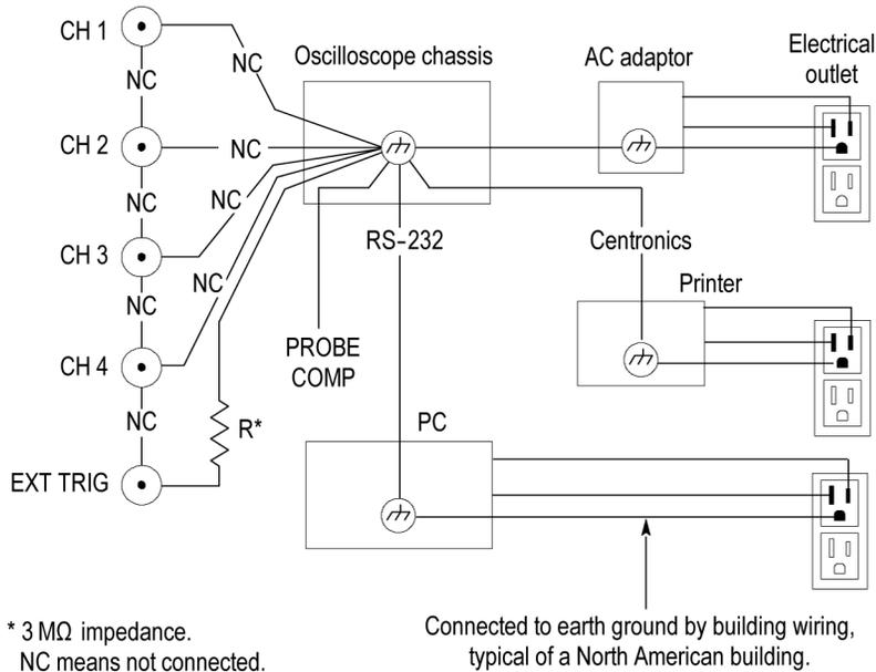
即使在示波器连接到接地的电源、接地的打印机或接地的计算机上时，示波器的输入仍然浮动。
