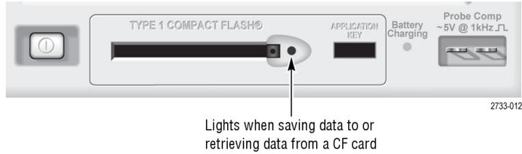
**TYPE 1 CompactFlash (类型 1 CompactFlash):** 插入用作移动存储器的 CompactFlash (CF) 卡。向 CF 卡保存或从 CF 卡检索数据时，旁边的 LED 灯变亮。请等到 LED 灯熄灭之后再拔掉 CF 卡。
