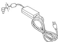
**示波器交流适配器及电源线。** (119-8727-XX) 请参阅“可选附件”了解可用国际电源线的清单。交流适配器额定温度为不低于 0 °C (+32 °F)，或不适于室外使用。（见表14）
