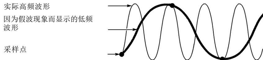
示波器精确表示信号的能力受到探头带宽、示波器带宽和采样速率的限制。要避免假波现象，示波器的采样频率必须至少比信号中的最高频率分量快两倍。
