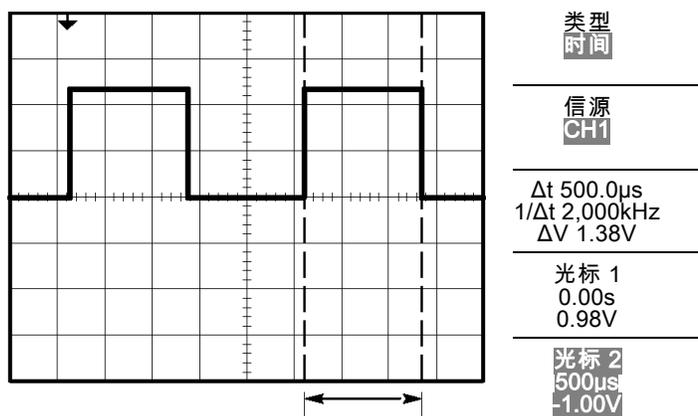
**说明：**“正频宽”测量可作为 Measure（测量）菜单中的自动测量。（见第100页，*测量*）
