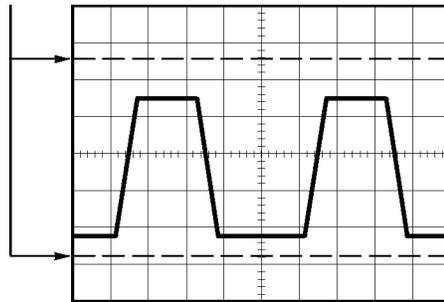
**光标** 使用此方法能通过移动总是成对出现的光标并从显示读数中读取它们的数值从而进行测量。有两类光标：“幅度”和“时间”。
