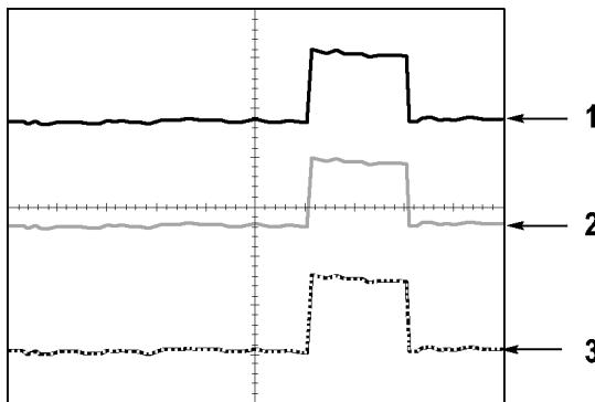
1. 實線波形表示波道 (顯示中) 的波形顯示。如果沒有任何控制發生變更，而致使顯示的精確度變的不確定，那麼當擷取停止時波形會保持實線。
