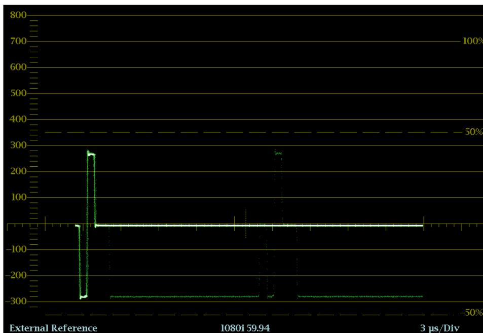
Рис. 20: Экран External Reference Waveform (трехуровневый синхросигнал)
