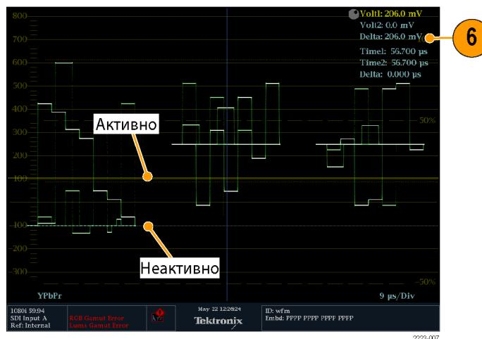
Рис. 53: Использование курсоров при отображении осцилограммы
