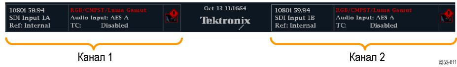
**Рис. 8: Страна состояния в режиме одновременных входных сигналов**
