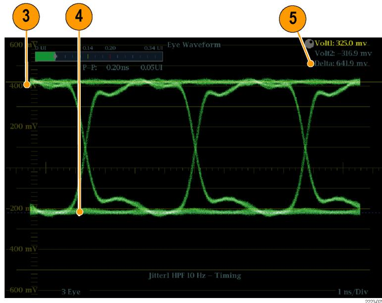
**Рис. 56: Установление курсора при измерении параметров глазковой диаграммы**
