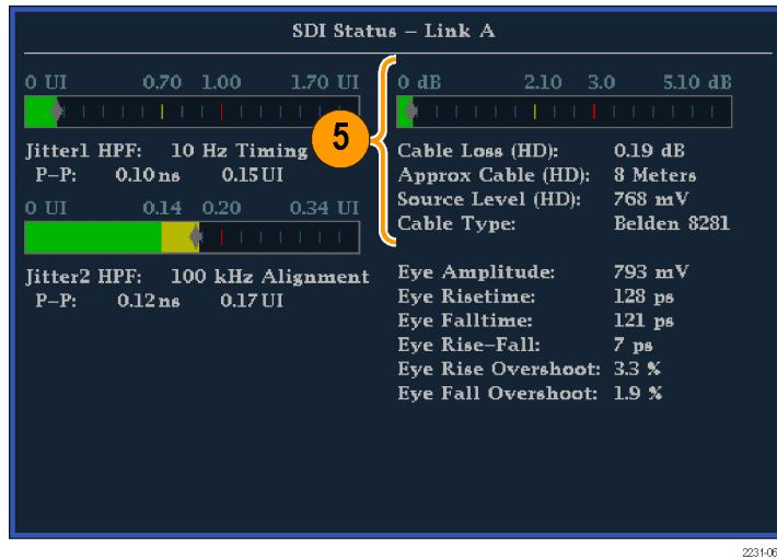
Рис. 61: Информация о потерях в кабеле в экране состояния SDI
