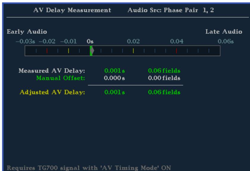
Рис. 33: Отображение AV Delay (задержка аудио/видео)
