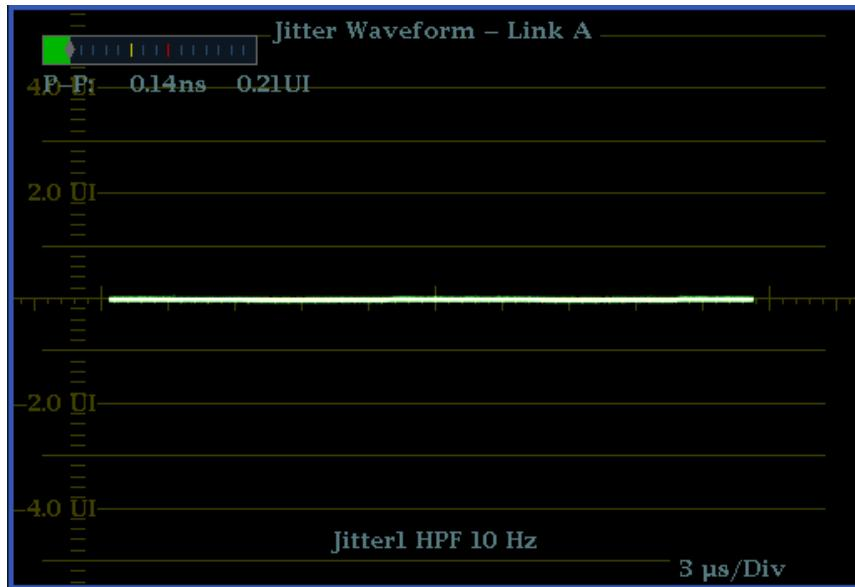
Рис. 36: Параметры джиттера при отображении в одном экранном окне (прибор работает в режиме четырех экранных окон)
