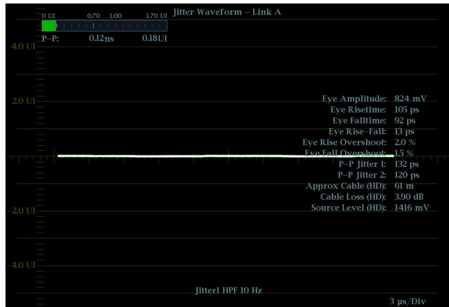
Рис. 37: Параметры джиттера, когда прибор работает в режиме одного экранного окна
