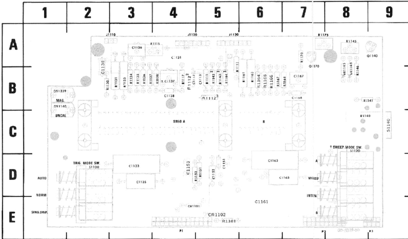
Fig. 8-11. A7—Timing circuit board.
